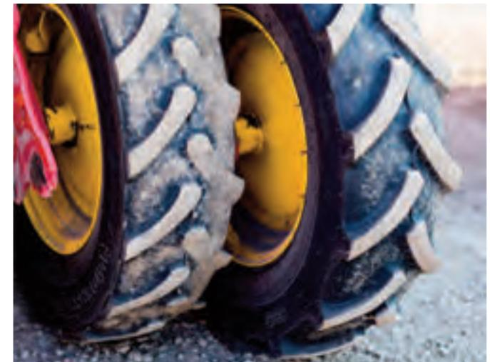
Die neue Bereifung für Rapid ( rechts im Bild ) haben eine größere Tragkraft und eine längere Lebensdauer.
