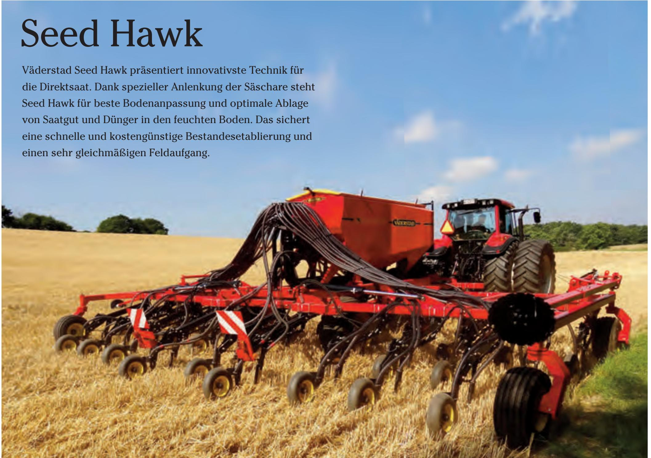
Der Saatgut-/Düngerbehälter bietet ein Fassungsvermögen von 3900 Litern. Dünger und Saatgut werden elektrisch dosiert und vom Gebläse zu den Scharen gefördert.
