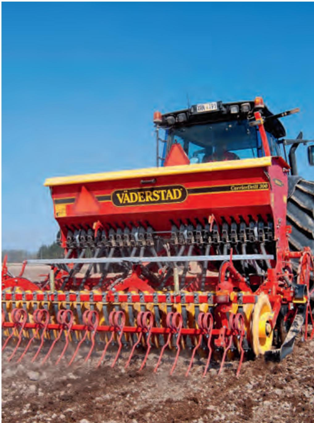
Die hängend angelenkten Abstreifer sorgen für saubere Walzenringe. Der federbelastete und leicht verstellbare Nachstriegel bereitet eine lockere Oberfläche.
