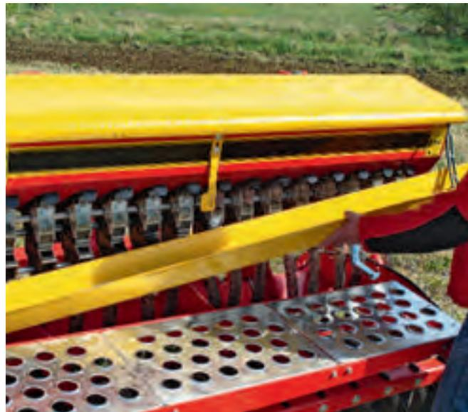
Die Abdreprobe ist einfach und schnell: Den Trichter unter die Dosierung halten und auf den Abrehschalter drücken, die Probe wiegen und den Wert in die Control Station eingeben. Fertig!
