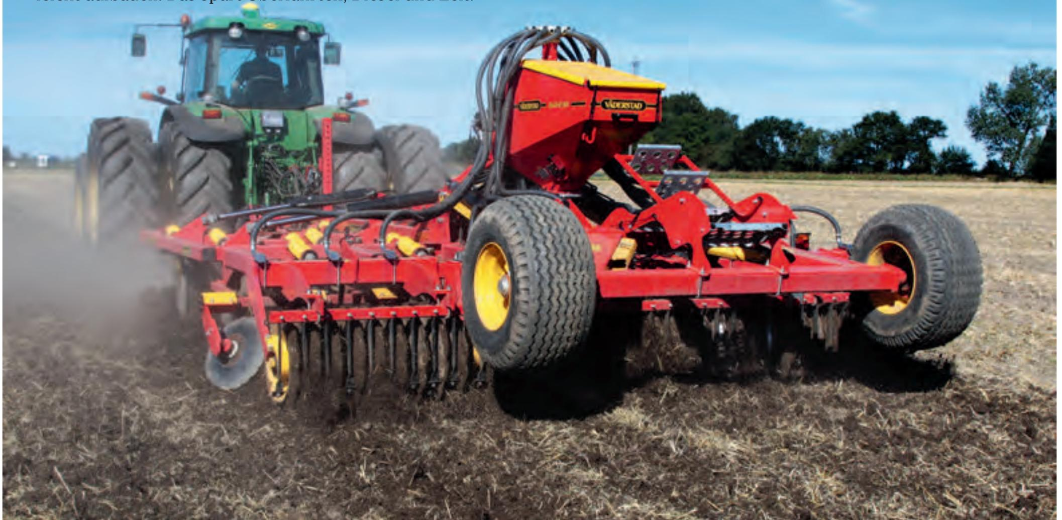
Der Saatgutbehälter hat ein Fassungsvermögen von 360 Litern und ist dank geringer Bodenhöhe zur Befüllung leicht zugänglich.
