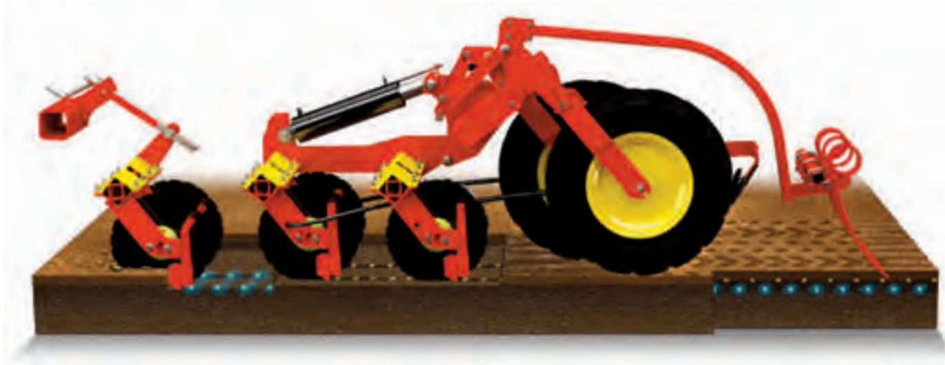
Ein echtes Plus bei Rapid ist die geniale Tiefenverstellung. Jeder Packerreifen führt zwei Säscharen in der voreingestellten Tiefe und übt gleichzeitig schonende Rückverfestigung aus.
