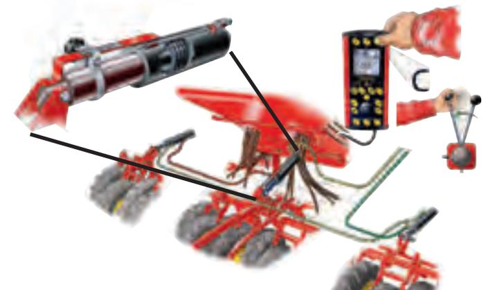
Die Saattiefeinstellung wird per Knopfdruck am Terminal aktiviert und dann mit einer Abweichung von 1 mm über einen die Traktorhydraulik verstellt.
