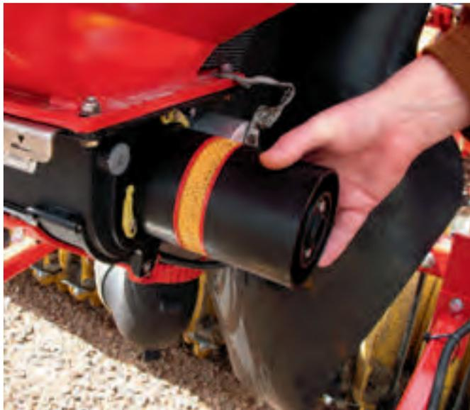
BDA 360 ist mit einer zentralen Saatgutdosierung mit wechselbaren Rotoren ausgestattet. Ein vom Gebläse erzeugter Luftstrom fördert die Saatkörner zu den Verteildüsen.
