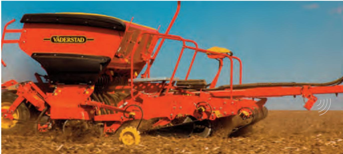
Die Saatstärke wird bei allen Rapid Modellen auf der Basis der Radarmesswerte gesteuert.
