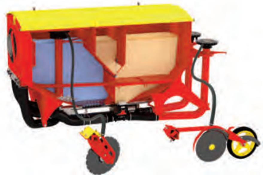
Spirit 600C ist mit Load Sensing (LS) Hydraulik ausgestattet. Daraus ergeben sich viele Vorteile: weniger Verbindungen, Bedienung von der Kabine aus, leichteres Wenden und Klappen. Die LS Hydraulik senkt zudem Leistungsbedarf und Öltemperatur und somit den Kraftstoffverbrauch.
