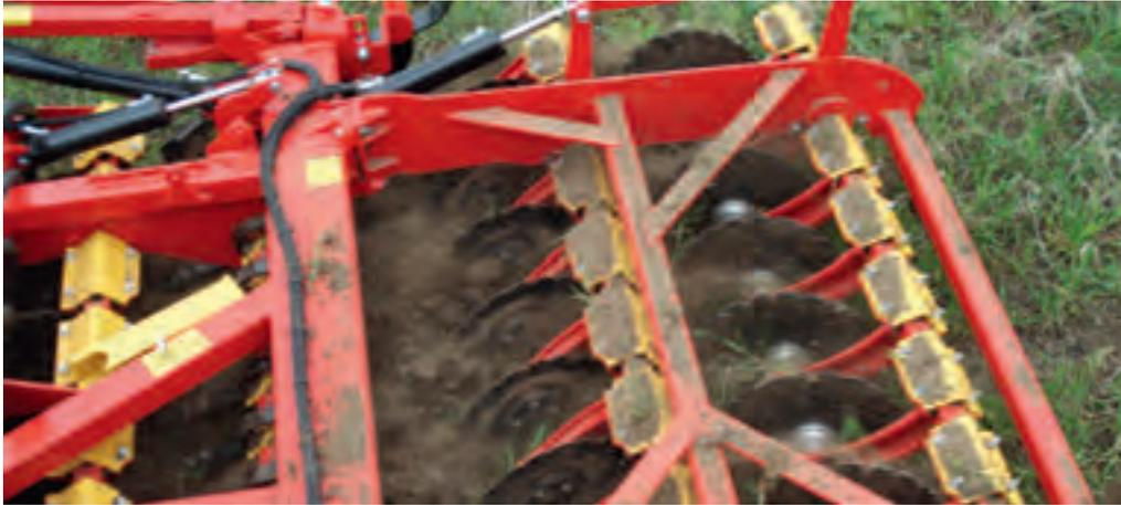
System Disc Aggressive ist das schwerste und gleichzeitig flexibelste Vorwerkzeug. Die Scheibenarme, Lager und Scheiben wurden von Carrier übernommen und sind so bemessen, dass sie problemlos große Mengen an Erde und organischem Material durchschneiden und durchmischen können. System Disc Aggressive: Scheiben mit einem Durchmesser von 450 mm.
