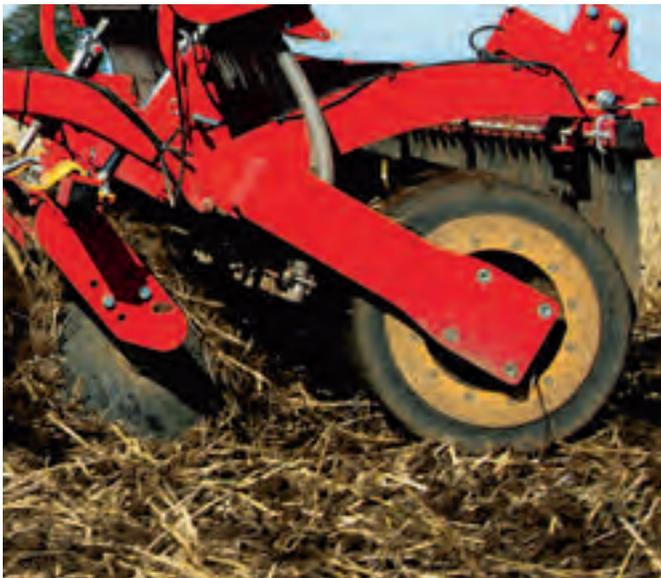
Die Saatgutablage erfolgt per Schwerkraft. Dazu fällt das Korn durch Schläuche und wird von der Druckrolle angedrückt. Saatgutverteilung und Genauigkeit sind nachweislich hervorragend.
