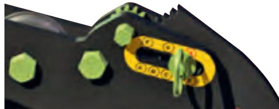
Die Saattiefe wird normalerweise entsprechend der feuchten Erdschicht und unabhängig von der Fruchtart eingestellt. Die Einstellung erfolgt einfach durch das Lösen eines Bolzens am Schararm und anschließender Einstellung einer 19 mm langen Passfeder. Die Ablagetiefe kann für jedes Säschar individuell verstellt werden.
