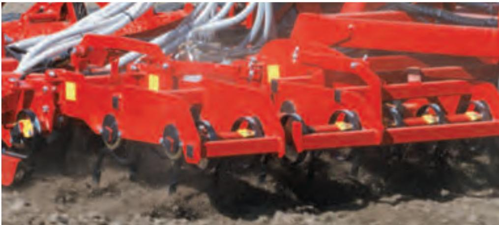
System Agrilla: Dieses Vorwerkzeug besteht aus zwei Reihen Agrilla Zinken in Kombination mit einem Cross-Board. System Agrilla kommt auf leichteren Böden zum Einsatz und dient der gründlichen Lockerung oder dem Aufbrechen verhärteter Oberflächen. System Agrilla unterbricht den Kapillartransport nach oben, ebnet die Oberfläche nach dem Pflug und plantiert feinkrümelige Erde zu einem Saatbett.
