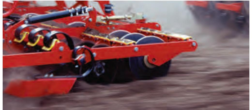
System Disc: der beliebteste und äußerst flexibel einsetzbare Vorwerkzeug besteht aus zwei Reihen intensiv arbeitender und in den Boden schneidender leicht konisch geformter Scheiben ( $\varnothing$  410 mm). Der Werkzeugbalken kann zur Einebnung der Oberfläche mit Cross-Board (Version "Light" oder "Heavy") ergänzt werden.
