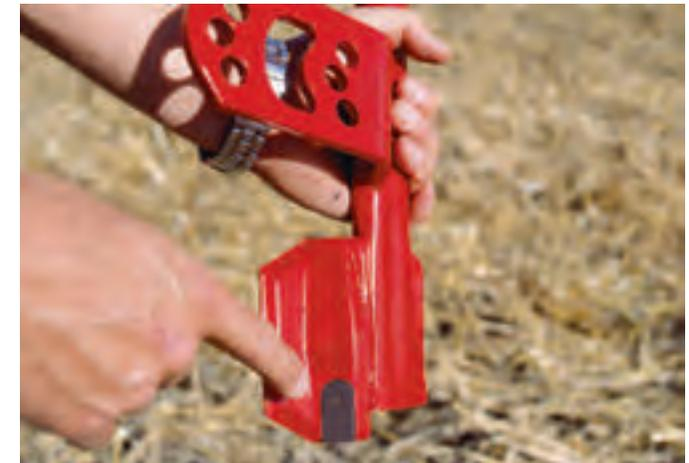
Auch Kleinigkeiten zählen: Die Sechsklinge verfügt über eine abriebfeste Beschichtung aus Wolframkarbid, das um ein Vielfaches verschleißfester ist als gehärteter Stahl.
