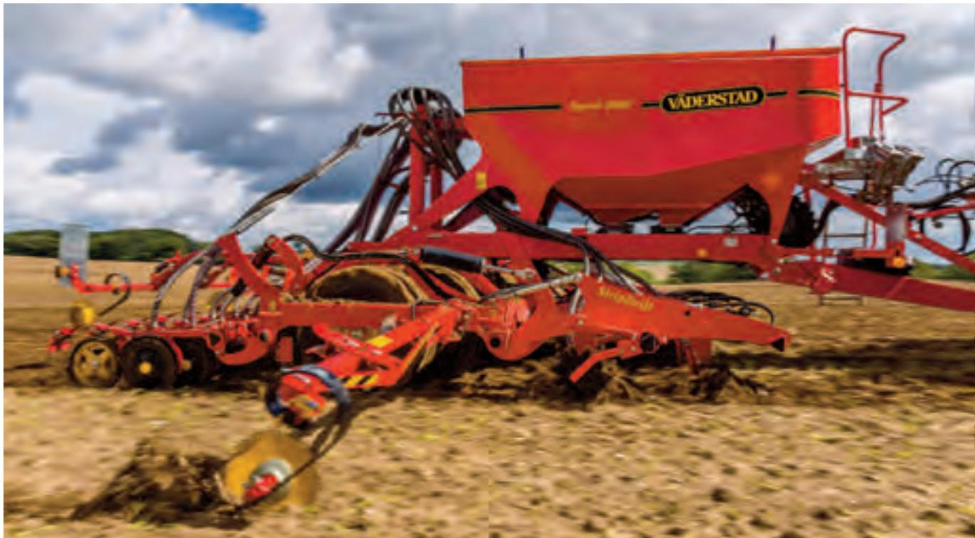
Das neue Vorwerkzeug StripDrill ist eine Weiterentwicklung für die Baureihe Spirit, arbeitet bis zu 30 cm tief und legt den Dünger auf zwei Ebenen ab.
