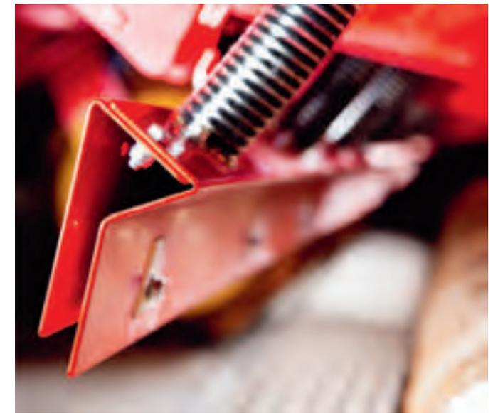
Die Verteilerplatte sorgt für gleichmäßige Verteilung der Saatkörner über die gesamte Arbeitsbreite der Carrier 420-1225.
