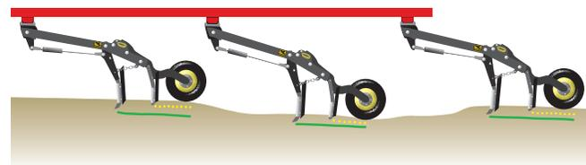
Jeder Schararm führt seinen Schar individuell mit gleich bleibendem Druck für beste Boden Anpassung. Das bedeutet, dass die einzelnen Rahmensektionen starr sein können und dass mit einer festen Rahmenhöhe gearbeitet werden kann, ohne dass die Saatgutablage leidet. Das Ergebnis ist eine robuste und einfache Konstruktion.
