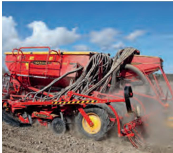
Alle Versionen des Modells BDA 360 verfügen über eine stabile, solide und CE-geprüfte Fahrerplattform für leichtes Befüllen des Saatgutbehälters. Die Leiter ist klappbar und wird für die Feldarbeit in Parkposition gesichert.
