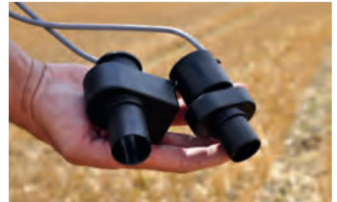
Eine Überwachungsanlage detektiert Verstopfungen in den Saat- und Düngerscharen. Die Sensoren senden ein Signal sobald der Saatgutstrom anfängt zu sinken. So kann das Problem sofort behoben werden.
