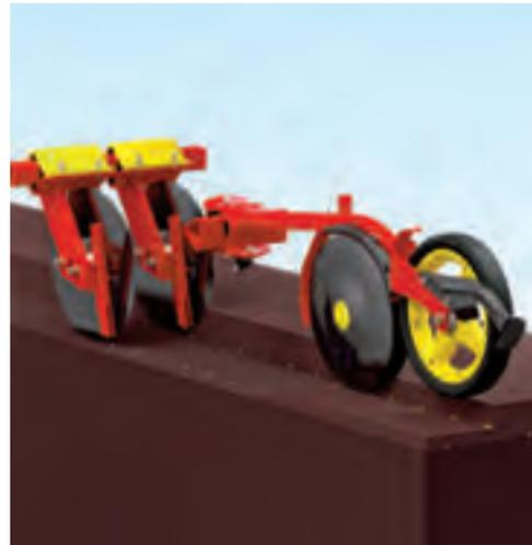
Bei der Methode FIX wird der Dünger in einem Reihenabstand von 12,5 cm eingearbeitet. Bei der Methode Nordic wird das Granulat in einem Reihenabstand von 25 cm abgelegt.
