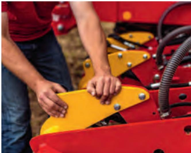
Die Umrüstung von Raps auf Getreide ist einfach. Die Vorerzeuge werden 8 cm verschoben während gleichzeitig versetzt angeordnete Säscharre geöffnet werden. Ein einfaches und bedienerfreundliches Konzept.
