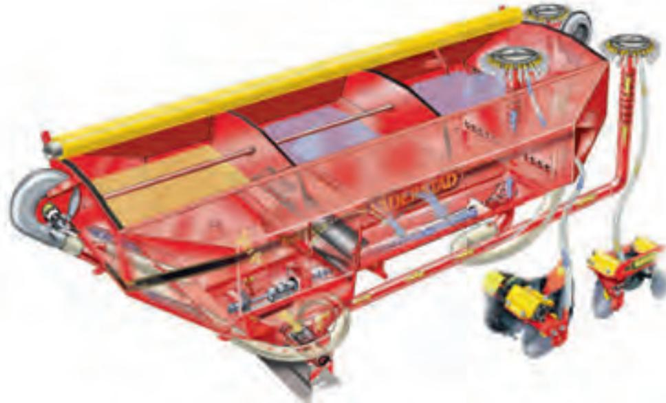
Bei Rapid A 600-800C wird über eine hydraulische Befüllschnecke der Dünger direkt in den Luftstrom des Verteilerkopfes gefördert. Wird nur Saatgut gedreht, wird die Förderrichtung der Schnecke reversiert, so dass das Saatgut in den vorderen Bereich des Behälters gefördert wird.
