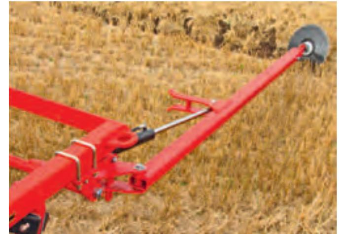
Robuste Spuranreißer mit angestellten Scheiben erstellen gut sichtbare Linien für den nächsten Gang. Wird mit der Aussaat in der Feldmitte begonnen, können beide Spuranreißer gesenkt werden.
