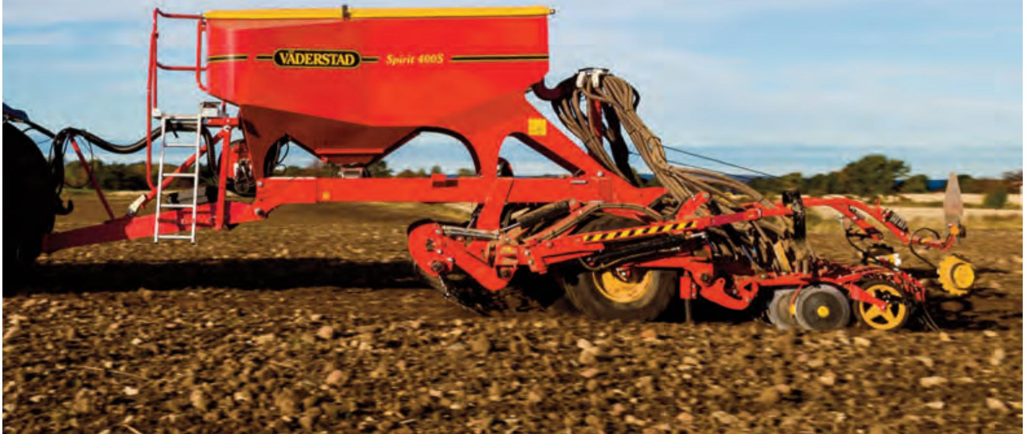
Das Gummilagerungskonzept TriForce verleiht der Maschine Stabilität und Flexibilität. Durch das dreieckige Profil des Balkens, für die Säagggregataufhängung erhält die Konstruktion mehr Elastizität für bessere Anpassung an Bodenunebenheiten und hohe Ablagegenauigkeit.
