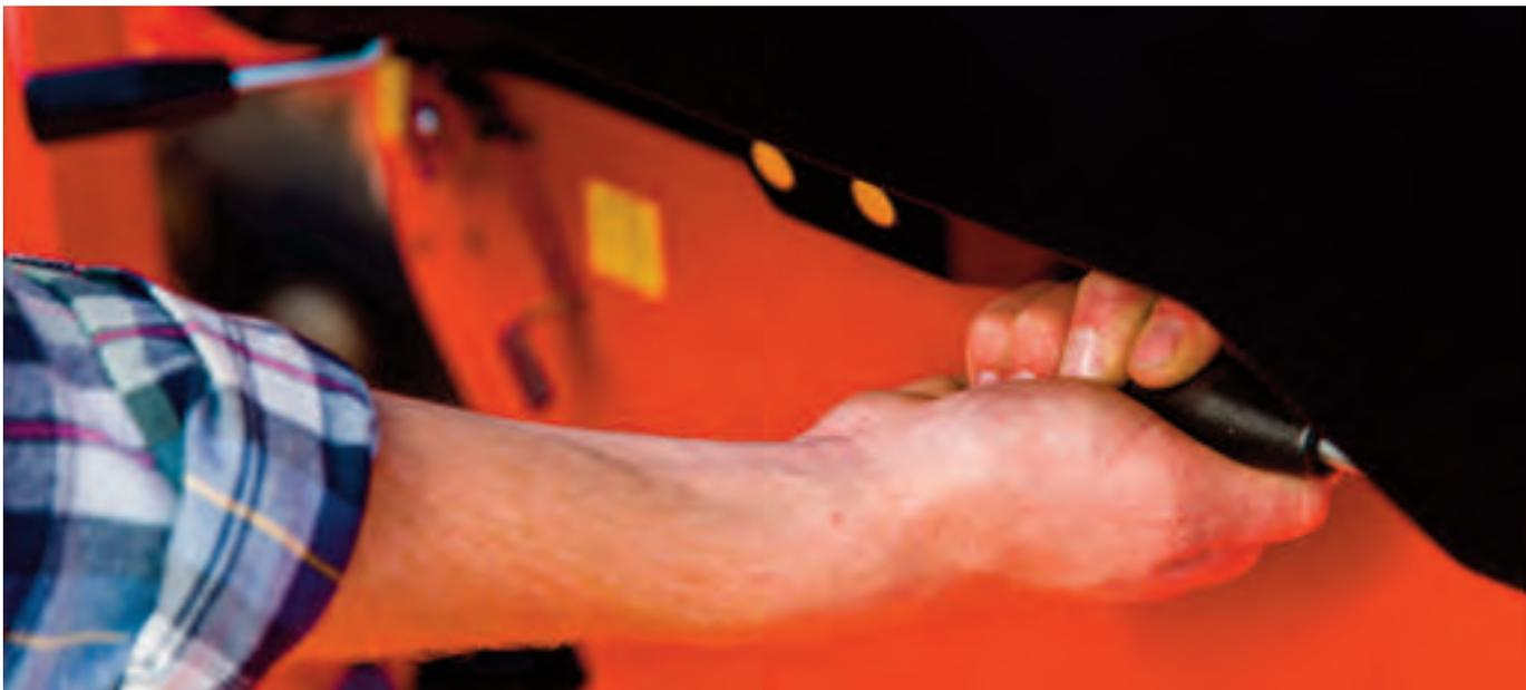
Einfache Bedienung der Halbseitenabschaltung bei Rapid 300-400 auf der rechten Maschinenseite.
