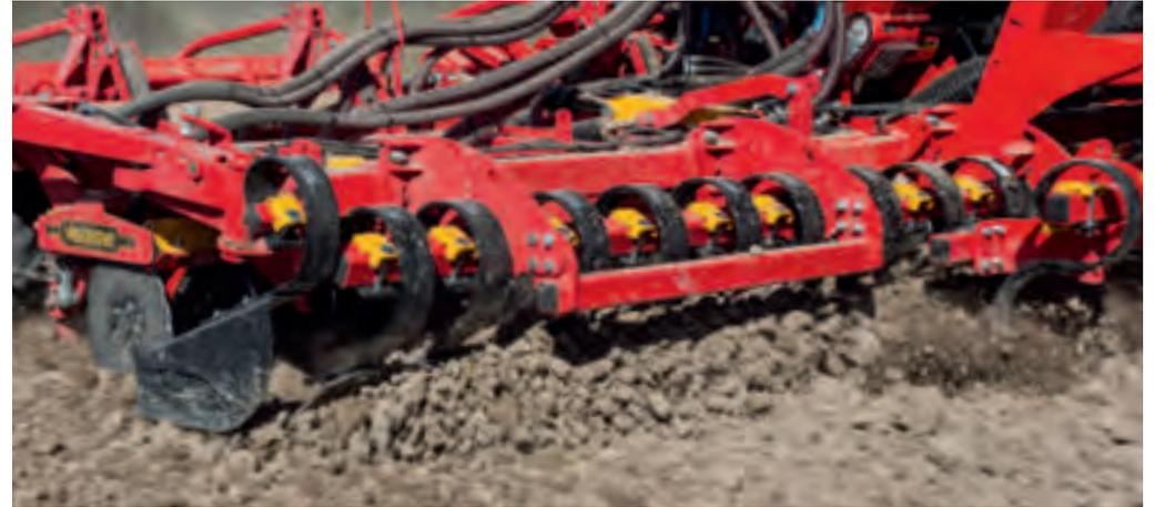
CrossBoard Heavy: Dieses Vorwerkzeug besteht aus gehärteten CrossBoard Zinken, die mit diversen Werkzeugen für unterschiedliche Bedingungen bestückt werden können. Gekrüpfte Spitzen stehen für aggressivere, gerade Spitzen für nachgiebigere Bearbeitung. CrossBoard Heavy ist für bearbeitete Flächen und effiziente Oberflächeneinbettung nach dem Pflug konzipiert.
