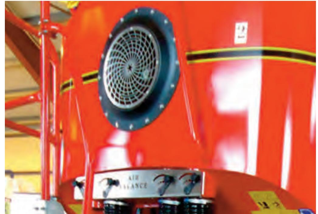
Das neu entwickelte und geräuscharme Gebläse ist besonders leistungsstark. Mit Air Balance wird der Luftstrom optimiert und die Ablagegenauigkeit verbessert.
