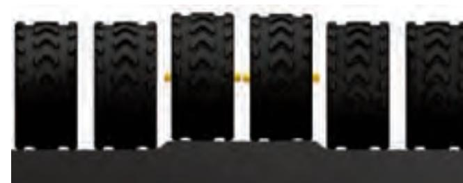
Die beiden mittleren Räder sind in einer speziellen Aufhängung gelagert, die für erhöhte Sicherheit auf unbefestigten Wegen sorgt.
