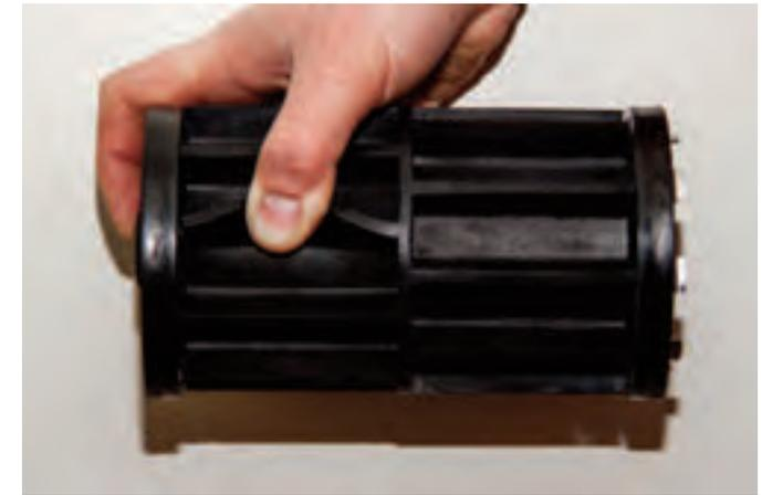
Die Dosierwellen aus Gummi schonen das Saatgut und sind korrosionsbeständig.
