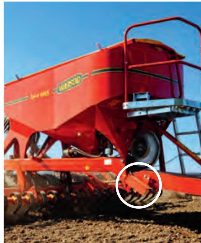
Für größtmögliche Präzision wird die Fahrgeschwindigkeit per Radarsensor gemessen.
