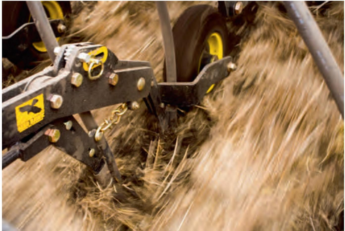
Die Säschar sind für längere Lebensdauer mit einer Hartmetallbeschichtung versehen.
