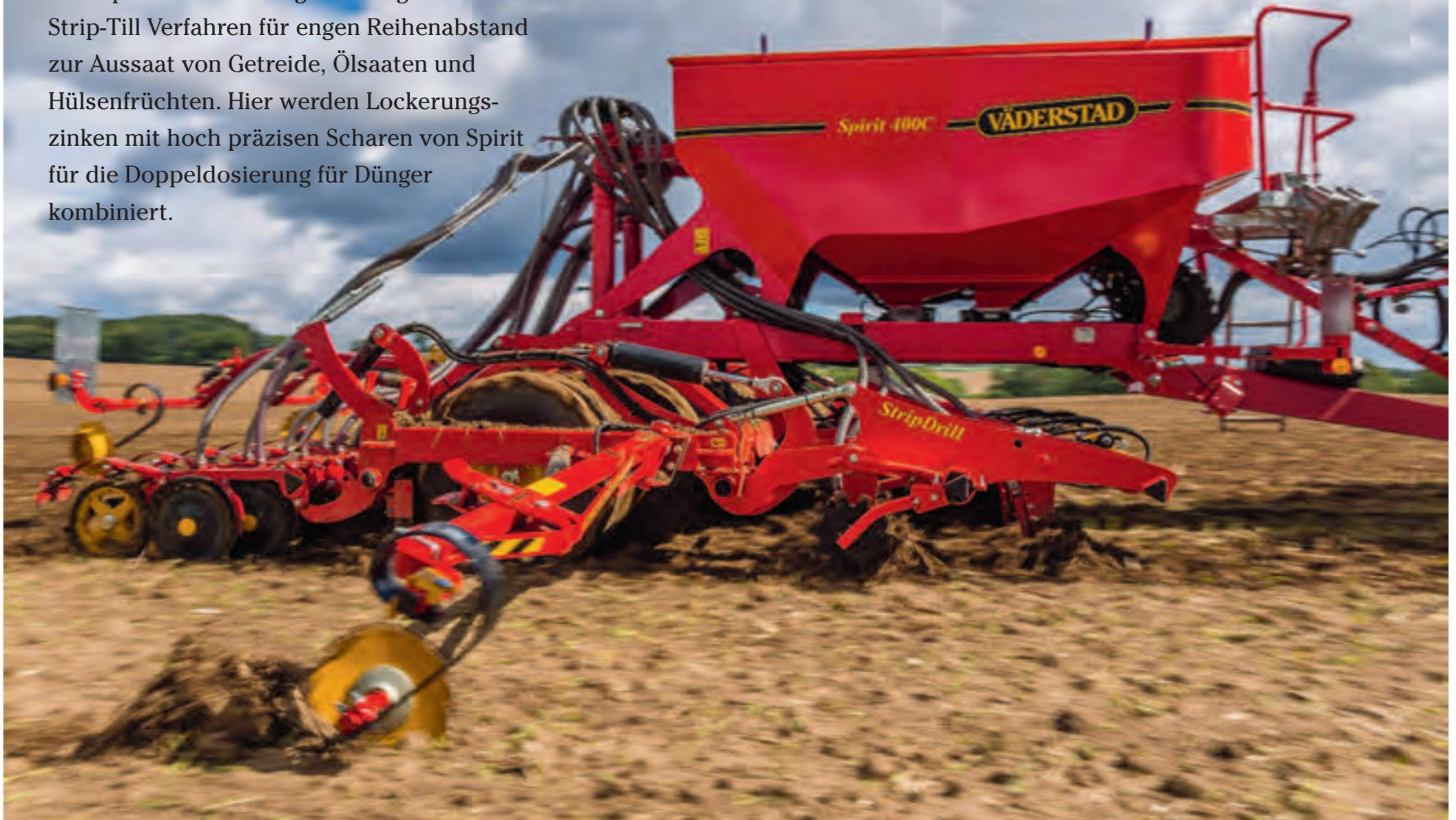
Das Gummilagerungskonzept TriForce verleiht der Maschine Stabilität und Flexibilität. Durch das dreieckige Profil des Balkens, für die Säaggregataufhängung erhält die Konstruktion mehr Elastizität für bessere Anpassung an Bodenunebenheiten und hohe Ablagegenauigkeit.
