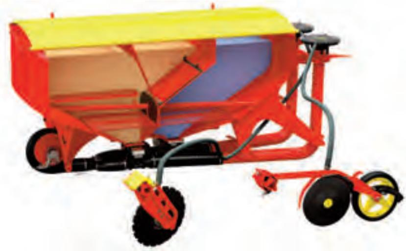
Beim großen Behälter mit 3900 Litern Fassungsvermögen wird das Verhältnis Dünger:Saatkorn auf einfache Art über eine Trennwand geändert.
