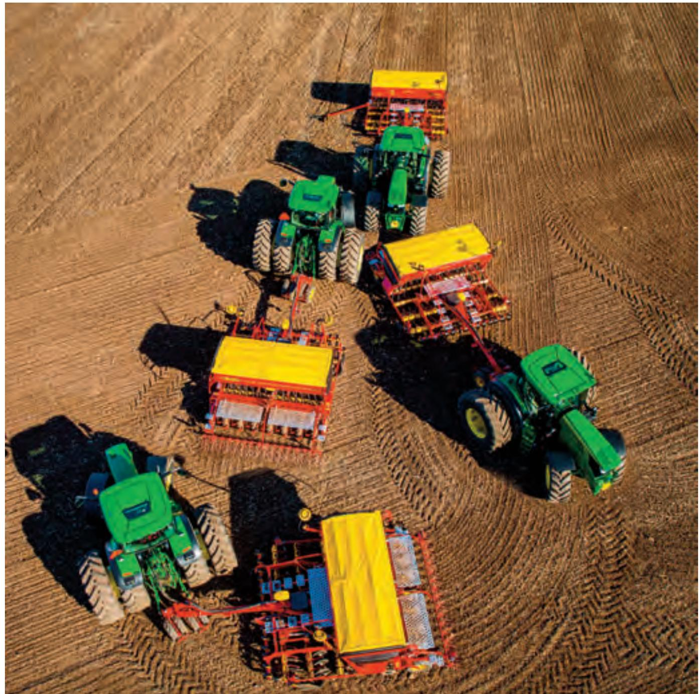
Der Druck des Nachstriegels kann vom Fahrersitz während der Fahrt erhöht werden. Das Verhältnis von Dünger und Saatgut lässt sich einfach verstellen.
