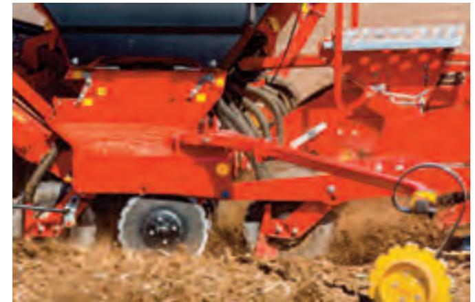
Die neuen wartungsfreien Lager finden sich sowohl an den Sä-scheiben als auch den Düngerscheiben, sowie am Werkzeugbalcken System Disc.
