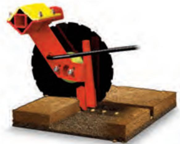
Die Ablagetiefe sollte immer etwas tiefer als die Arbeitstiefe des Vorwerkzeuges eingestellt werden. Anschließend wird das Saatgut mit feinkrümeliger Erde bedeckt, die der Werkzeugbalken nach oben gefördert haben.
