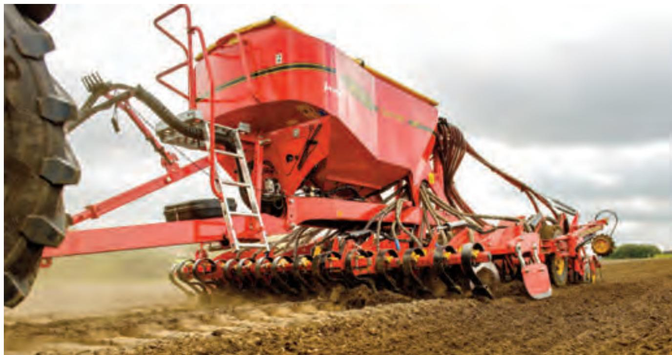
Bei der Methode FIX wird der Dünger als Breitband und in einem Reihenabstand von 12,5 cm abgelegt.
