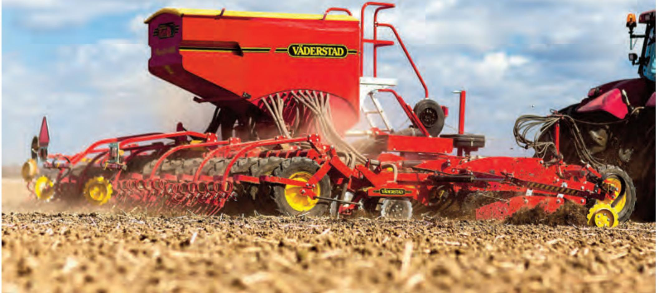
Großer Behälter mit verstellbarer Trennwand zur Befüllung mit Saatgut und Dünger.
