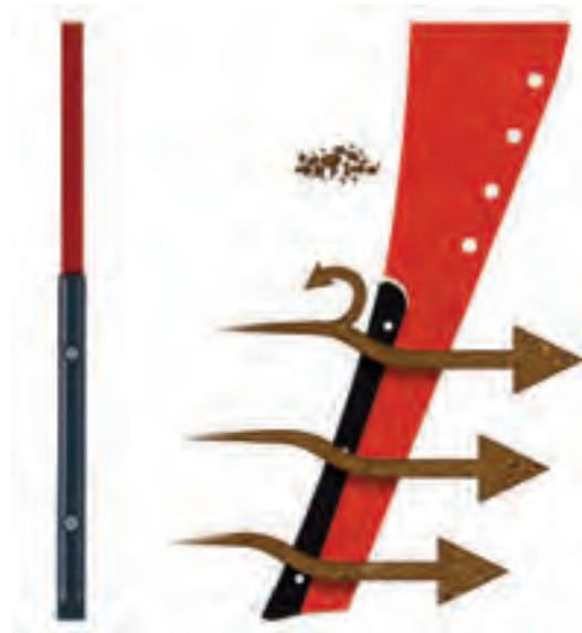
Schmale Zinken verhindern Klutenbildung und senken den Zugkraftbedarf. Die glatte Oberfläche hinterlässt eine offene Furchenwand.
