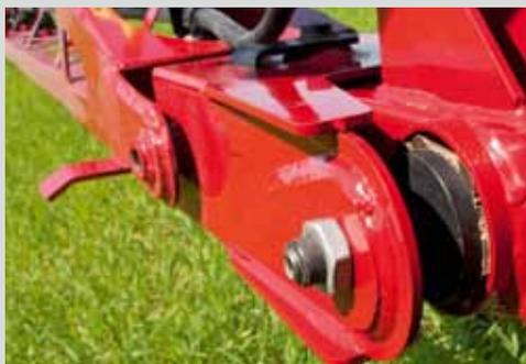
Integrierte AntiSwing Dämpfer im Pendel reduzieren Gestängebewegungen. Die PRO VP Gestänge mit 20, 21 und 24 m haben zusätzlich integrierte Schwingungsdämpfer auf den Gestängeauslegern.
