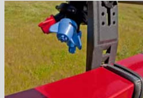
Die Düsenkörper sind hinter und oberhalb des Gestängerahmens montiert und somit vor Beschädigungen geschützt.
