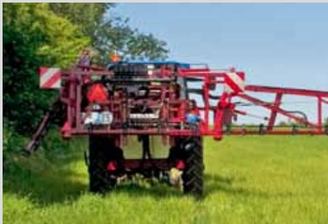
Die EAGLE Gestänge können mit zwei verschiedenen Hydraulikausstattungen geliefert werden. Y-Version: Bedienung über Schlepperhydraulikventile - symmetrische Klappung der Ausleger und Höhenverstellung (1 x DW, 1 x EW erforderlich). Z-Version: Mit elektro-hydraulischer Bedienung - ermöglicht Neigungsverstellung der Einzelarme und einseitige Klappung. Ein hydraulischer Hangausgleich ist bei beiden Versionen Sonderausrüstung.
