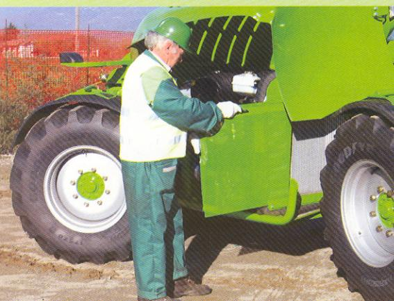
Der Motor kann durch Drehen um die Vertikalachse aus dem Motorraum herausgezogen werden.
