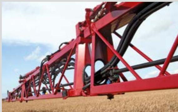
Die Gitterkonstruktion des Gestänges sorgt für eine hohe Stabilität und verhindert Verwindungen. Somit wird eine exakte und gleichmäßige Spritzverteilung gewährleistet. Die Düsen, Spritzleitungen und Schläuche liegen geschützt im Gestänge.
