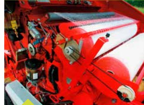
Die gebogene Breitziehvorrichtung führt das Netzmaterial an die Ballenkanten und um diese herum.
