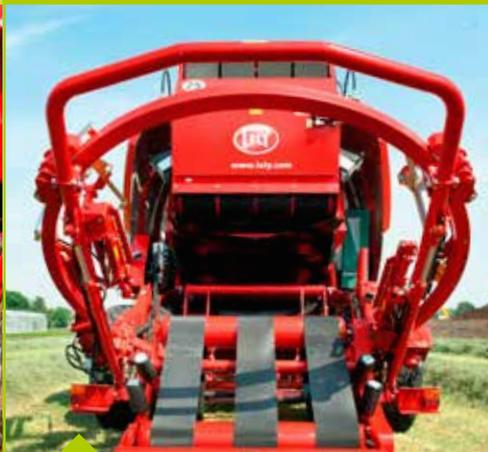
Vorsichtiges Ablegen des Ballens auf dem Boden dank der niedrigen Position des Wickeltisches.
