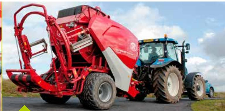
In Transportposition extrem kompakt, aufgrund fast vertikaler Ausrichtung des Wickelrings.
