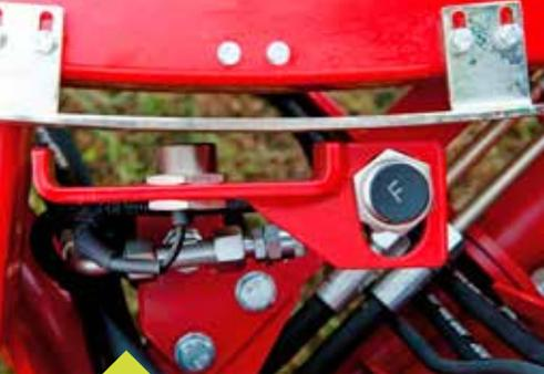
Einfacher Folienrissensor: Im Falle eines Folienrisses kann der Ballen mit der restlichen Folie umwickelt werden oder der Ring hält an und die gerissene Folie wird repariert – programmgesteuert über die Handsteuerung.
