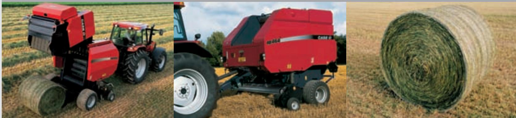
Die Pickup ist 2,3 m breit. Auf Wunsch mit verschiedenen Schwadniederhaltern, die die Leistung bei unterschiedlichem Erntegut optimieren.
