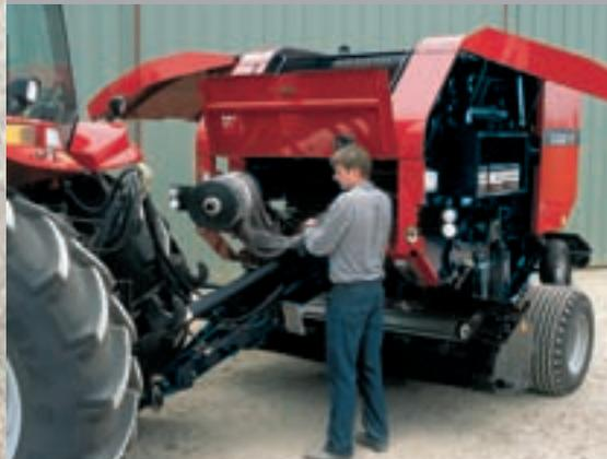
*Die Zentralschmierung senkt Verschleiß und Wartungsaufwand.*
