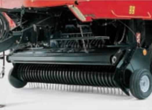
Zwei Tristräder mit Niederdruckbereifung für optimale Bodenanpassung in allen Verhältnissen.
