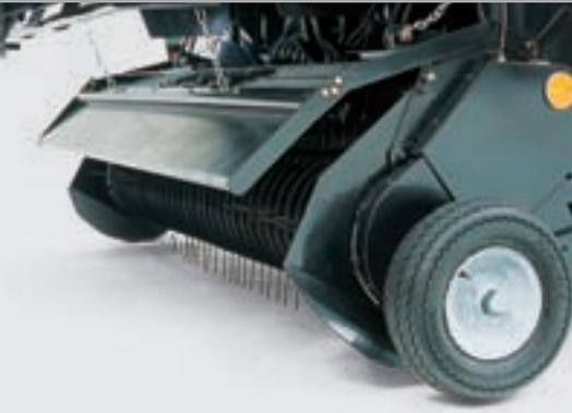
Der zweistufige Schwadniederhalter, der den Erntegutfluss unterstützt, passt sich dem Schwad an und sorgt für einen gleichmäßigeren Druck auf das Erntegut.
