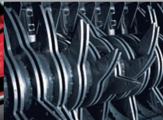
Walzen aus Riffelblech geben dem Ballen während des Pressvorgangs sicheren Halt.
