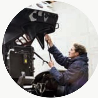
Einteilige gasdruckgefederte Motorhaube in zwei Positionen angehoben werden (45°/90°), sogar mit angebautes Frontanbaugerät.
