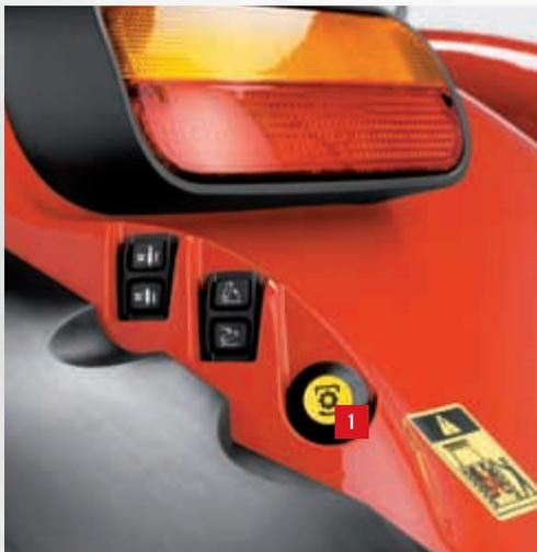
1 Schalter hinten am Kotflügel für Heckzapfwelle, Hubwerk und Steuergerät
