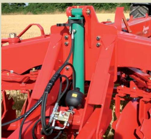
Die Tiefenführung und Druckeinstellung der Nachläufereinheit kann mit Spacern am Hydraulikzylinder je nach Bodenbedingungen optimal angepasst werden. Ein Druckspeicher sorgt für einen reibungslosen Arbeitseinsatz, auch unter schwierigen und steinigen Bedingungen.
