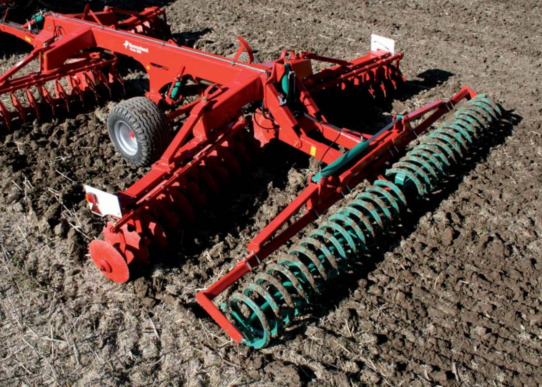
Die Visio 200 kann mit einer großen Anzahl von Nachlaufwalzen ausgerüstet werden.
