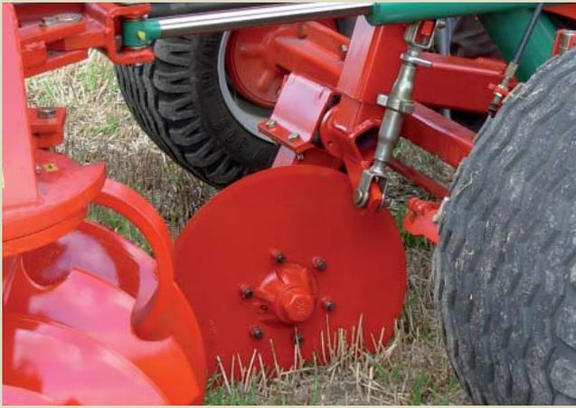
Der Scheibenstabilisierer gewährleistet eine sichere Führung der Visio 200 auf unebenem Gelände. Angebracht hinter dem Fahrwerk, lässt er sich einfach über eine Spindel einstellen.
