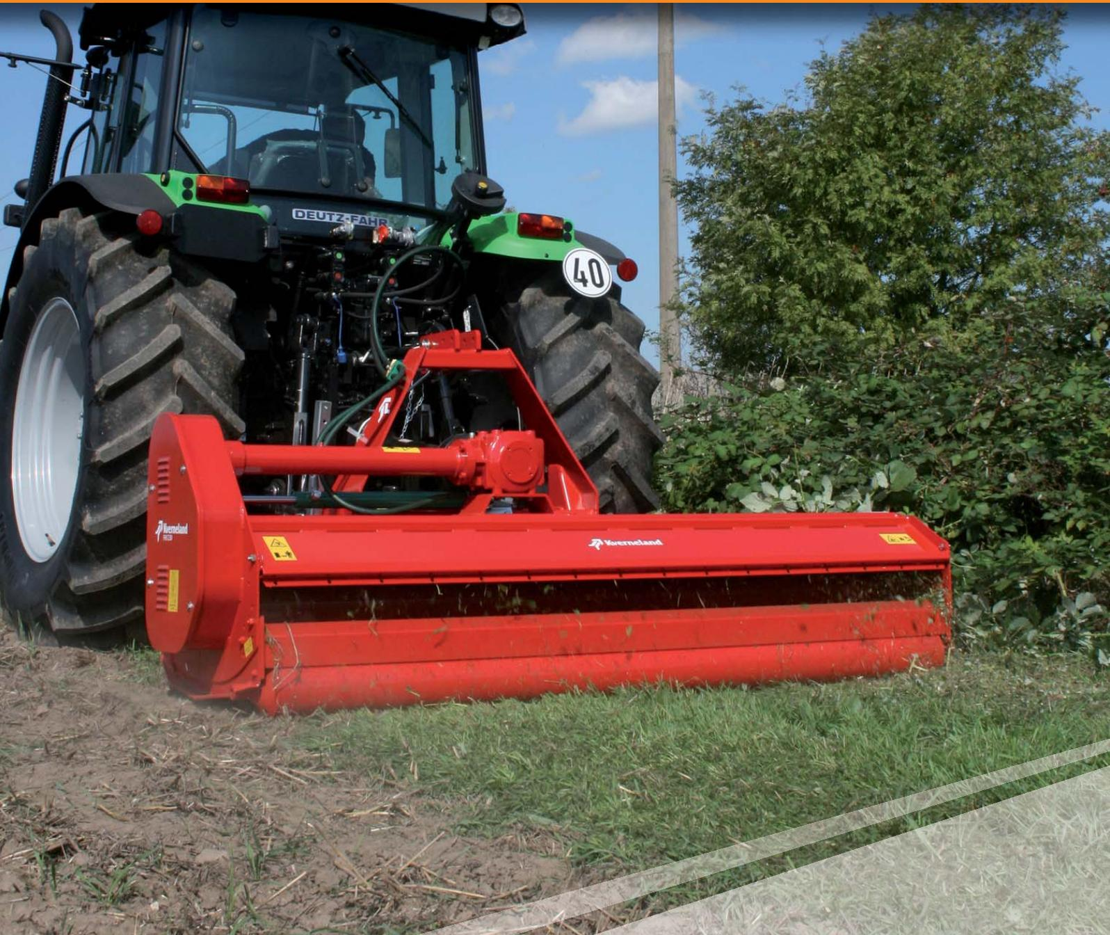
Der Mulcher Kverneland FHS, für Traktoren bis zu 80 PS, ist eine kompakte Hochleistungsmaschine für den Einsatz in Obstplantagen, im Weinbau und für Flächen mit geringeren Aufwuchsmengen. Ebenso können Weiden und Grünflächen ausgemulcht bzw. Stroh- und Stoppelflächen nach der Ernte abgemulcht werden.
