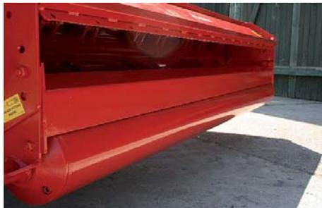
Die nachlaufende Stützwalze hat standardmäßig einen Durchmesser von 160 mm. Der einstellbare Abstreifer sichert ein perfektes Ergebnis.
