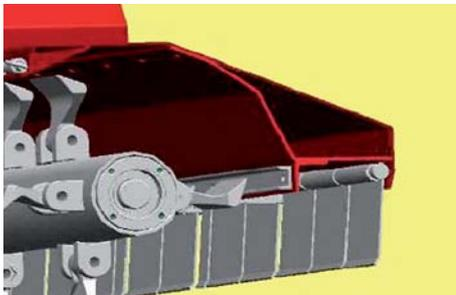
Standardmäßig wird der Rahmen oberhalb des Rotors doppelt verstärkt. Standarddicke 4 mm.
