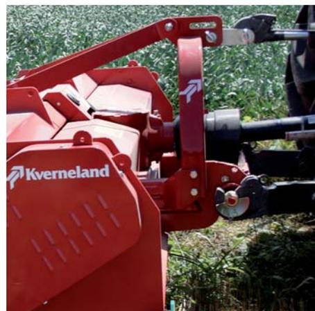
Die Halbautomatische Anhängung (Kat III) ermöglicht ein schnelles Ankuppeln des FXZ. Zusätzlich sorgt das Langloch im oberen Koppelpunkt für eine gleichmäßige Tiefenführung ohne zusätzliche Kräfteinwirkung auf den Anbauturm.
