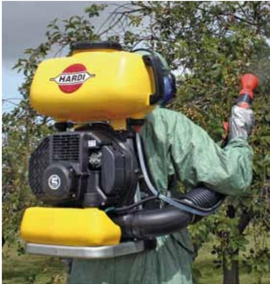
Das Motor-Rückensprühergerät BPM100 verfügt über ein Zentrifugalgebläse und wird zur Bekämpfung von Schädlingen und Krankheiten in Bäumen, Flächenkulturen und in Gebäuden eingesetzt.
