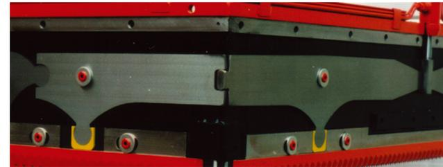
Der BvL Topstar schafft dank des patentierten und bewährtem Doppelmesserschneidsystem einen unübertroffenen glatten Schnitt an der Silofläche. Selbst bei härtester Silage arbeiten sich die sechs Messer ruhig durch den Silostock. Alles sechs Messer bestehen aus einem hochverschleißfesten Stahl und werden mit nur einem Zylinder angetrieben. Die sechs Messer bewegen sich dabei in dem gekapselten Schneidbügel gleichzeitig.
