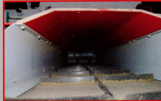
Hohe Förderleistung dank 700 mm breitem Förderkanal in bewährter BvL Förderbandqualität
