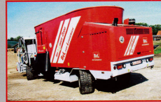
Leichtes Rangieren mit Hundegang
