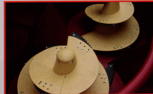
Einzelangetriebene, unabhängig regelbare Mischschnecken für optimale Mischqualität (0 - 50 min -1 )
