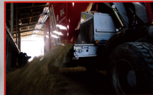
Querförderband mit stufenlos regelbarer Bandgeschwindigkeit. Optional 300 mm verschiebbar.
