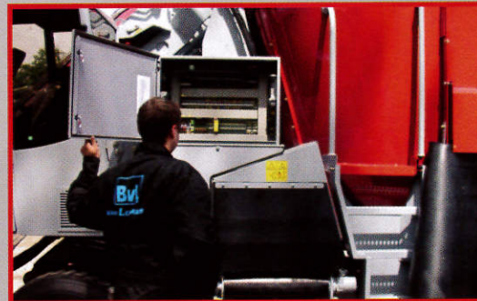
Die Schaltzentrale des MaXimus ist leicht von außen zu erreichen. Kommunikation über CAN-Bus
