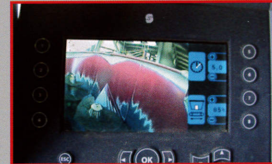
Behälterkamera und Rückfahrkamera im One-Display-Design integriert
