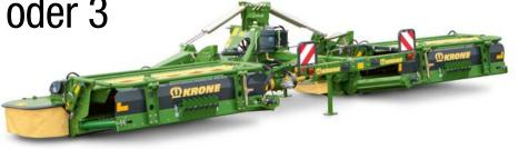
mit Stahlzinkenaufbereiter, die EasyCut B 870 CR und B 1000 CR mit Rollenaufbereiter von der Breit- bis hin zur Einzelschwadablage vielseitig einsetzbar. Die leistungsstarken Förderbänder überzeugen auch in schwersten Beständen. Das Einsetzen und Ausheben erfolgt hydraulisch einzeln oder gemeinsam. Beim Ausheben wird der Bandantrieb automatisch abgeschaltet.
