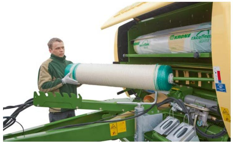
liegt im Sichtbereich, so dass Sie auch während der Arbeit einen guten Überblick haben. Beim Einlegen des Bindematerials stehen Sie bequem vor der Maschine. Das Netz wird auf die ausgeschwenkte Aufnahmewelle geschoben und der Bindeeinrichtung zugeführt.
