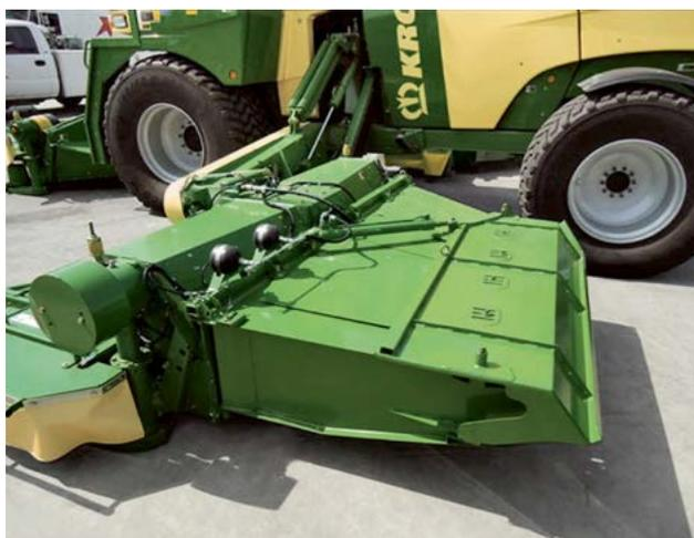
**Hydraulisch klappbare Seitenschutz**
