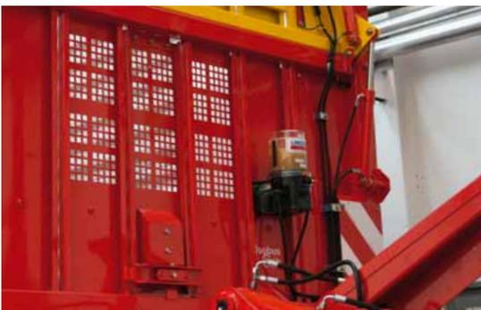
Eine automatische Zentralschmierung für alle Schmierstellen ist ebenfalls optional erhältlich.
