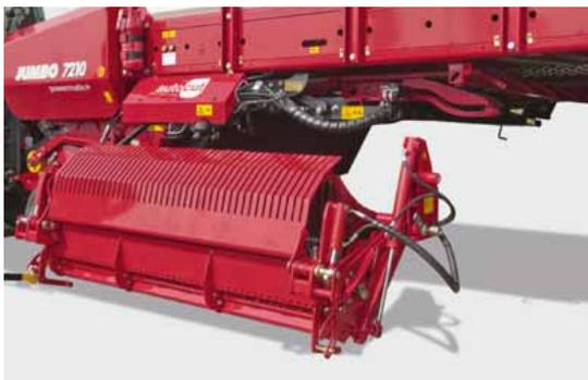
Die Druckfedern und Kipphebel der bewährten Einzelmessersicherung befinden sich im geschützten Bereich. Das reduziert die Verschmutzung der Messerhalterungen erheblich. Bei jedem Ausklappen des Schneidbalkens säubert der Schmutzabweiser die Messer-Zwischenräume.
