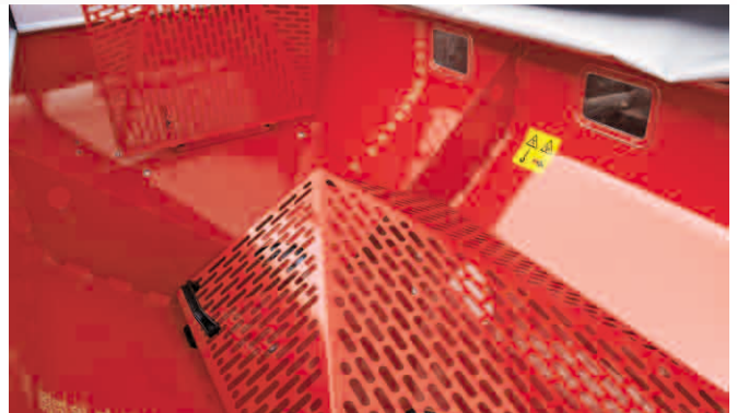
Geöffnetes Sieb in geparkter Position
