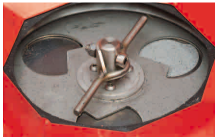
Langsam drehender Rührfinger
