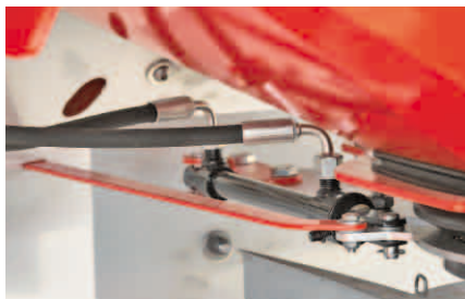
Edelstahlkupplungen an den Hydraulikschläuchen
