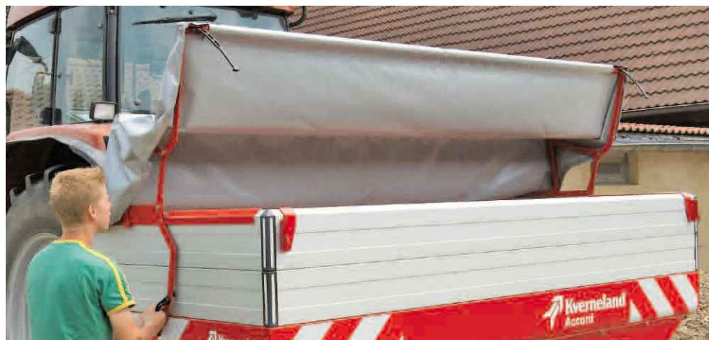
Bedienerfreundliche Rührfinger Trichterabdeckung (optional)
