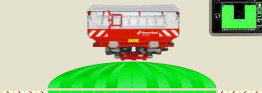
Verringern der Streubreite auf beiden Seiten um 8m
