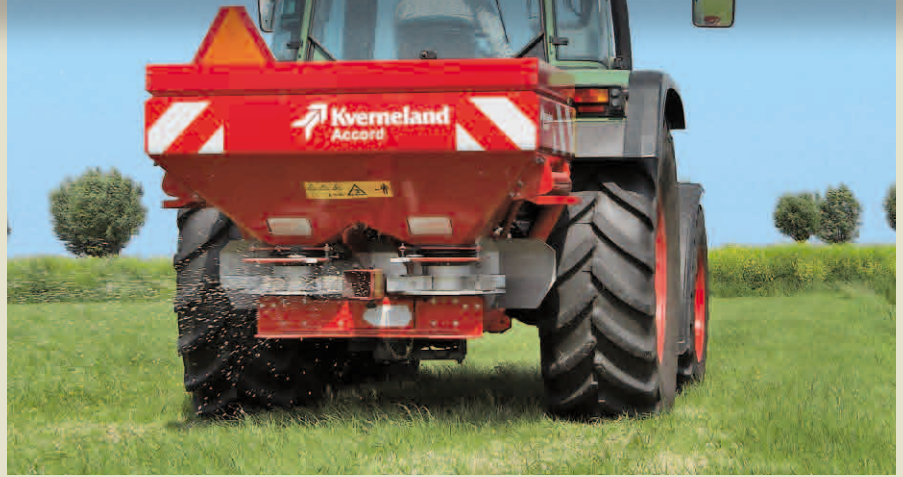
Grenzstreuen bei Verwendung der Grenzstreuplatte
