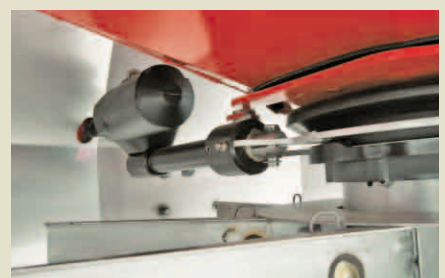
Speziell abgedichtete Spindelmotoren sorgen für besten Korrosionsschutz
