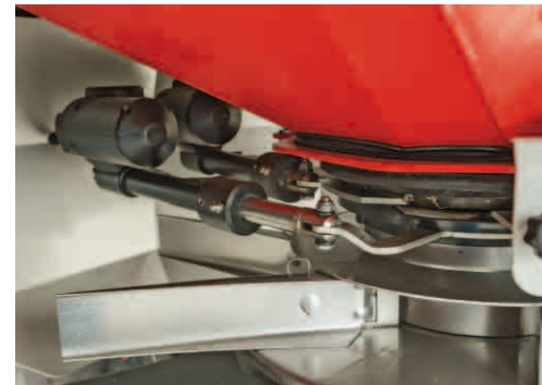
Zwei Stellmotoren auf jeder Seite steuern den Aufgabepunkt und die Ausbringungsmenge
