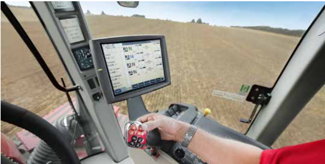
Einfache Bedienung der Zusatzsteuergeräte per Joystick, der bei den Modellen mit 8 Steuergeräten Standard ist.
