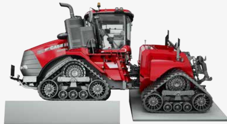
26° Pendelwinkel nach oben und unten
