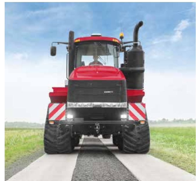
Ein Fahrwerk für Quadtrac-Modelle - unter 3 m Gesamtbreite
