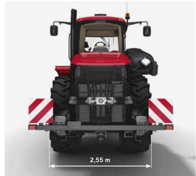
Selbst mit 800er Bereifung hat der Steiger-Traktor eine Gesamtbreite von 2,55m.
