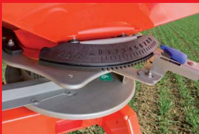
AXIS-M 50.1 W: Elektrisch fernbediente Aufgabepunktverstellung
