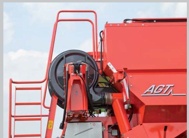
Zwei Hochleistungsgebläse sorgen für einen kontinuierlichen Düngertransport
