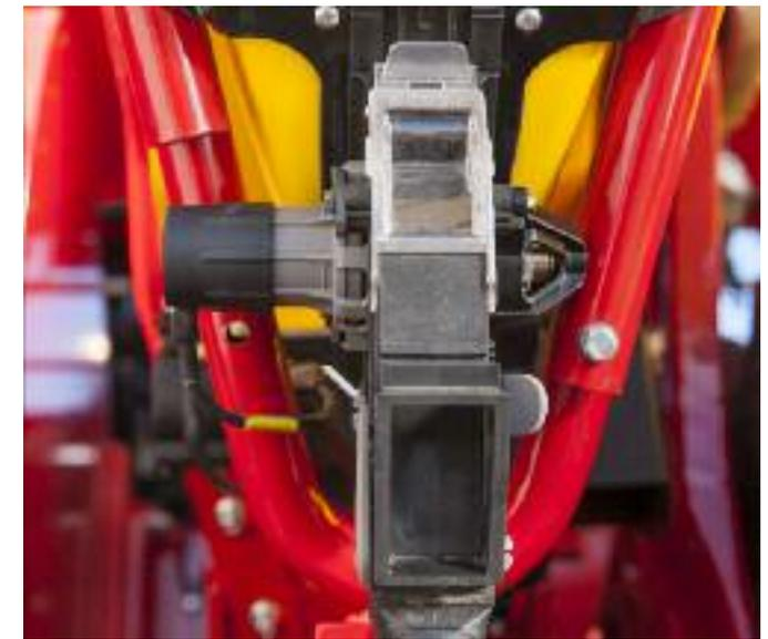
Die Düngerdosierung ist ähnlich aufgebaut wie die der Rapid, doch fällt hier das Granulat nicht per Schwerkraft durch das Fallrohr sondern wird durch einen Luftstrom aktiv in die Furche gefördert.
