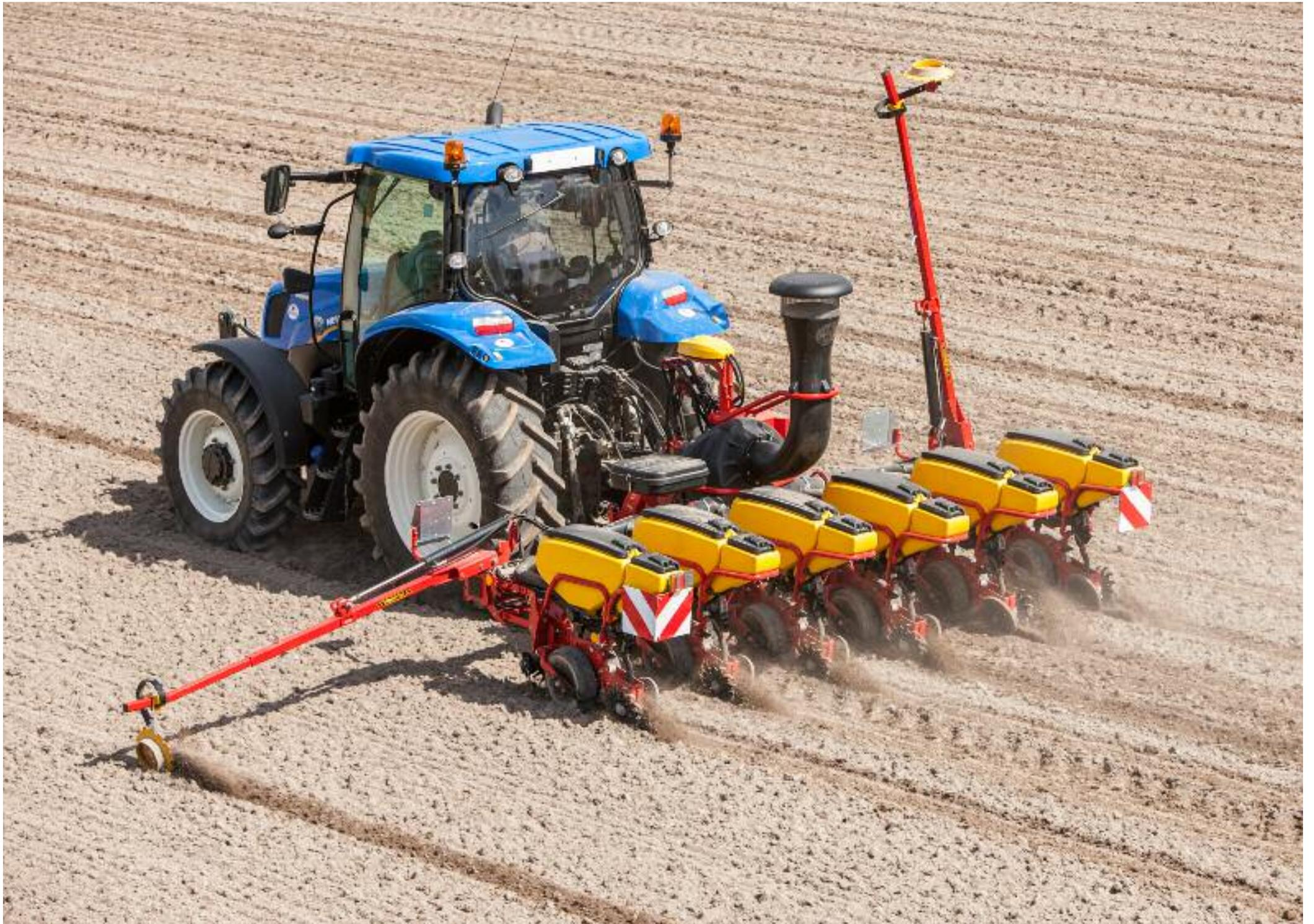
Das Fassungsvermögen des Saatguttanks beträgt 70 Liter. Das reicht bei acht Reihen für eine Fläche von etwa 20 Hektar – mit einer einzigen Saattankfüllung.
