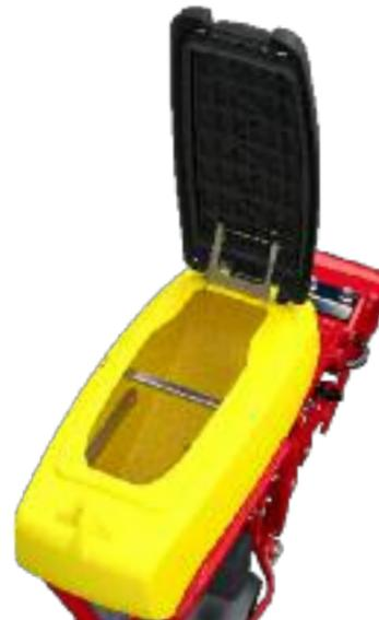
Das Fassungsvermögen des Saatguttanks beträgt 70 Liter. Das reicht bei acht Reihen für eine Fläche von etwa 20 Hektar – mit einer einzigen Füllung.
