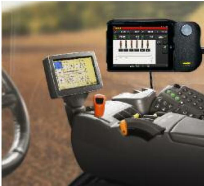
Dem Fahrer werden die Saatmenge und Arbeitsgeschwindigkeit angezeigt. Das Balkendiagramm am unteren Anzeigenrand zeigt die Ablagegenauigkeit in den einzelnen Reihen.
