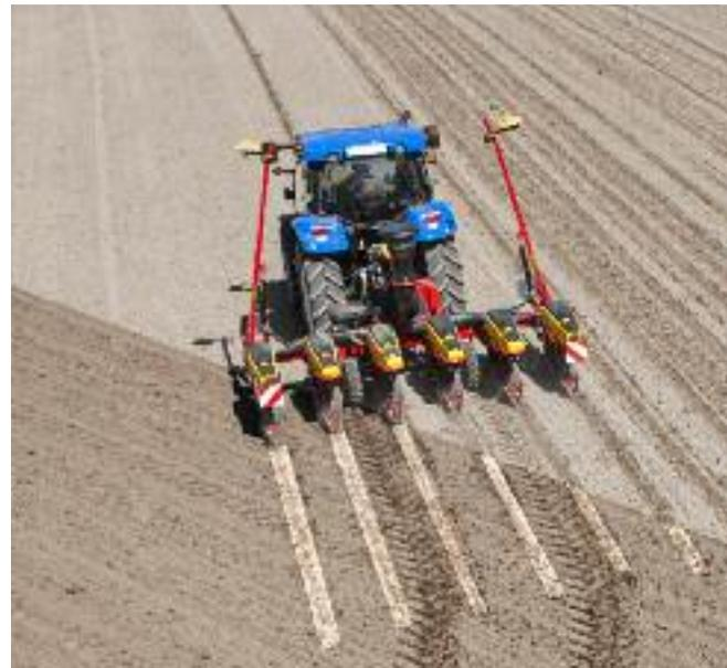
Da jedes Säherz über seinen eigenen Elektroantrieb verfügt, ist jedes Säaggregat separat abschaltbar.
