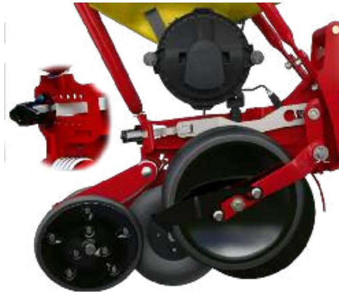
Die Arbeitstiefe lässt sich einfach über einen Hebel anpassen, der den Abstand zwischen Tiefenführungsrad und Säscheibe verstellt. Der große Vorteil dieser Anlenkung ist größere Leichtzügigkeit und weniger Vibrationen in den Säaggregaten.
