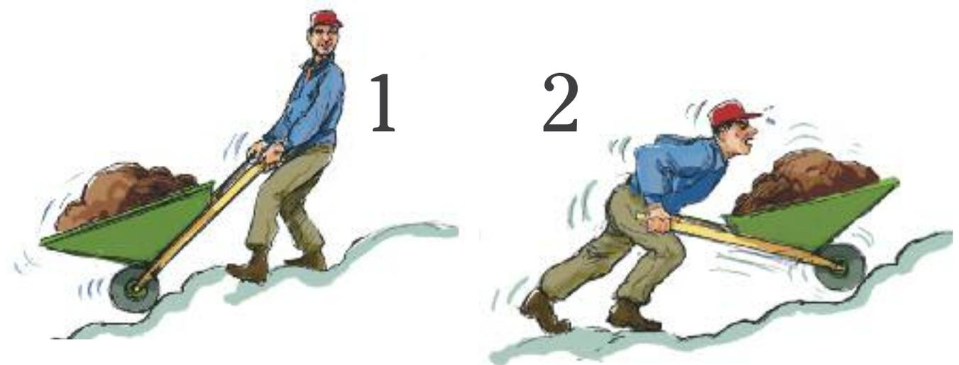
Die Tiefenführungsräder der Tempo sind gezogen aufgehängt (1) und nicht, wie bei Einzelkorndrillen üblich, geschoben (2). Der große Vorteil dieser Anlenkung ist größere Leichtzügigkeit und weniger Vibrationen in den Säaggregaten.
