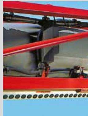
Die Winkelverstellung der Düsen/Lufteinheit ist die einzigartige und wichtige Besonderheit der HARDI TWIN Technik, dadurch kann die Spritzflüssigkeit gezielt im Bestand angelagert werden.
