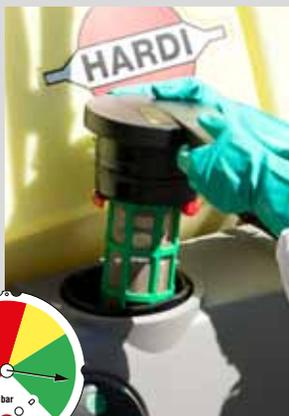
Das COMMANDER Filtersystem besteht aus dem exklusiven HARDI EasyClean Filter und dem CycloneFilter.
