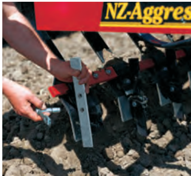
Eine mit Einzelmessern ausgestattete und am CrossBoard montierte Schiene, das SingleKnife, sorgt für einen noch besseren Bearbeitungseffekt. Die Schnellwechsellmesser können bei Bedarf ohne Werkzeug getauscht werden.
