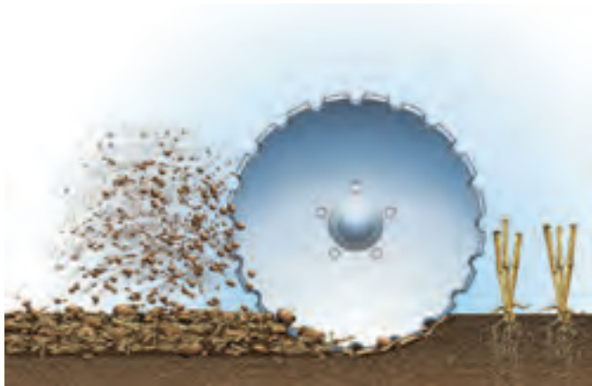
Die konische Scheibe hat einen größeren Lockerungs- und Krümeleffekt als die Hohl­scheibe.
