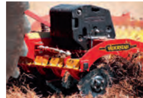
Ein optionales Zusatzgewicht erhöht das Gewicht bei den Modellen Carrier 300-400 um 400/800 kg.
