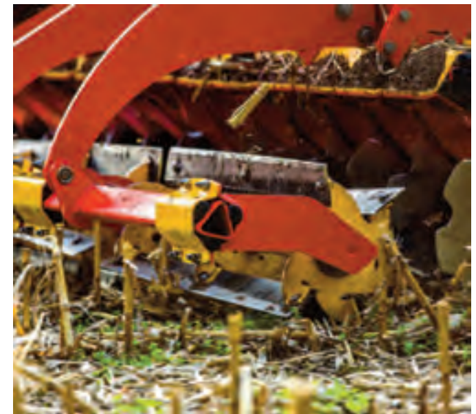
Kurze Messer und ein kleiner Walzendurchmesser garantieren gute Bodenadaptation und hohe Drehzahl.
