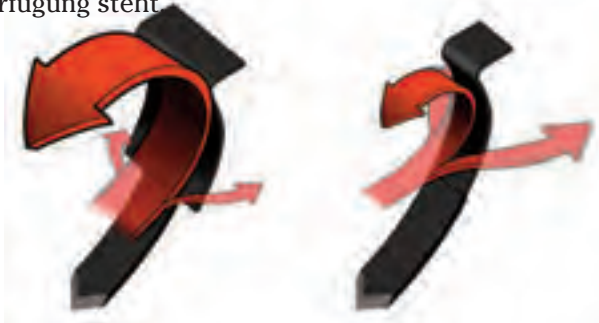
Je nach Breite des Leitblechs wird mehr oder weniger Boden durchmischt.
