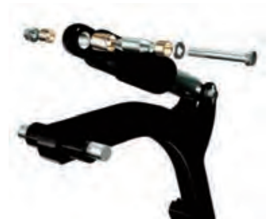
Der Zinken ist über einen konisch gebuchten Spezialbolzen mit dem Rahmen verschraubt, wartungsfrei und daher besonders langlebig.
