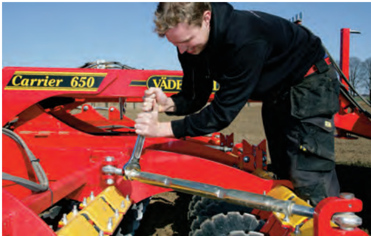
Die Balken sind für optimale Arbeitsergebnisse seitlich verstellbar.
