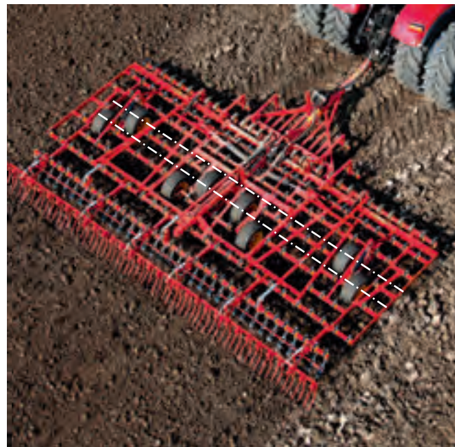
Die versetzt angeordneten Boogie-Räder - eine Konstruktion, die Väderstad "OffSet" nennt - sichern zusätzliche Fahrstabilität bei hohen Arbeitsgeschwindigkeiten auf unebenen Flächen.
