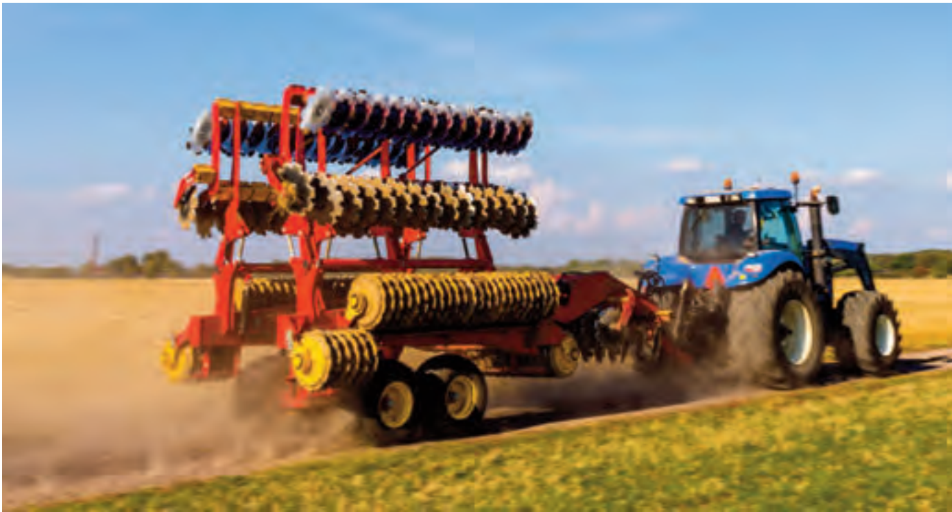
Carrier XL 9.25 und 12.25 bieten die spezielle Väderstad Klappung. Damit erreichen sie eine Transportbreite von nur 3 m.
