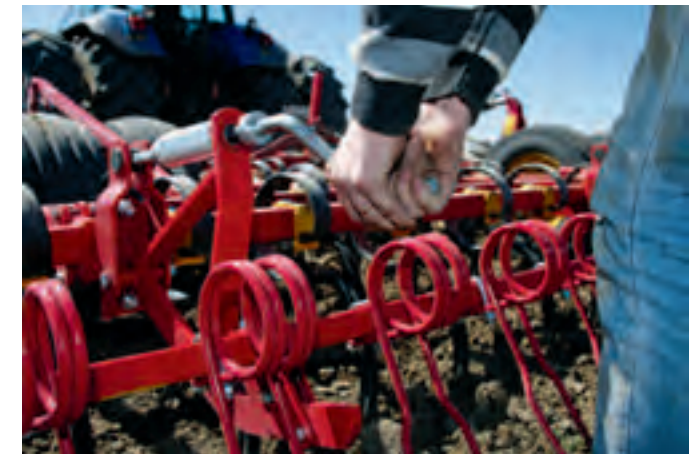
Der nachlaufende Saatstriegel bietet dank Federung eine gute Boden Anpassung, sowie eine optimale Einstellung der Arbeitstiefe.
