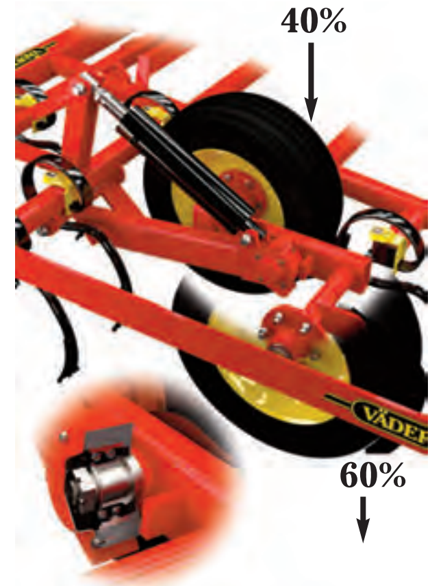
Das vordere Boogie-Rad trägt dabei 40 % der Last, das hintere 60 %. Diese Lastverteilung sorgt selbst auf unebenen Flächen und bei hohen Geschwindigkeiten für eine erstaunlich gute Boden Anpassung. Die quer zur Achse ausgerichteten Kugellager nehmen möglichen Seitenzug auf.
