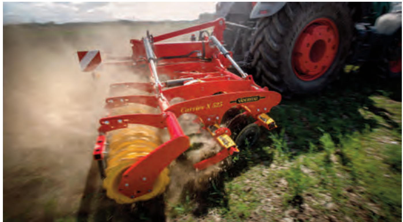
Dank X-förmiger Anordnung der Scheiben kann das Gerät auch GPS-geführt werden. Die Scheibenanstellung sichert guten Einzug.
