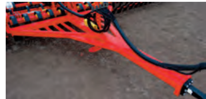
Die neue Deichsel ist 200 x 100 mm im Querschnitt, mit einer 10 mm dicken Wandung. Zum Vergleich die Maße des Vormodells: 120 x 120 x 8 mm Wandung.
