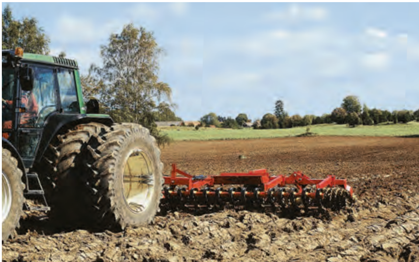
Ausgestattet mit dem Crossboard kann die Walze sogar Pflugfurchen nivellieren.
