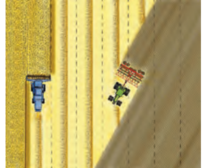
Carrier mit Strohriegel wird diagonal zur Ernterichtung gefahren.
