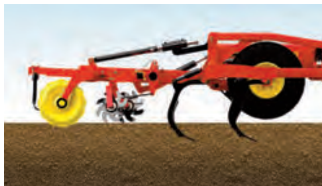
Auf sehr trockenen Böden kann das gesamte Gerätegewicht auf die Walze übertragen werden.
