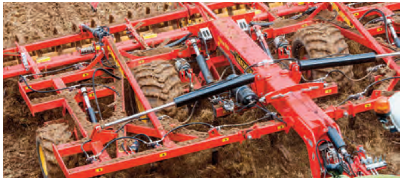
Bei Ausstattung mit den Tiefenlockerungszinken "DeepLoosening" kann Opus sogar Pflugsohlen in einer Tiefe bis zu 40 cm aufbrechen. Zur Senkung des Zugkraftbedarfs kann Opus auch mit Scharspitzen des Typs "LowDisturbance" sowie Klappzinken ausgestattet werden.
