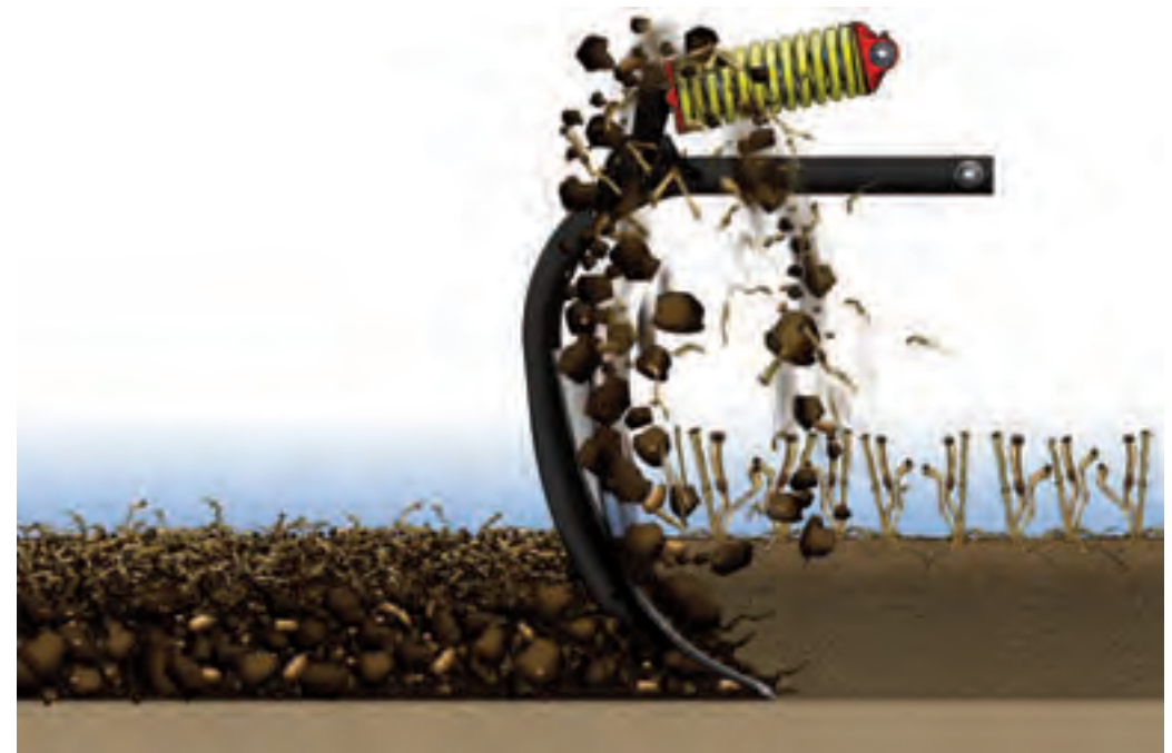
Bei Twist verbleiben mehr Pflanzenrückstände in der Oberschicht.
