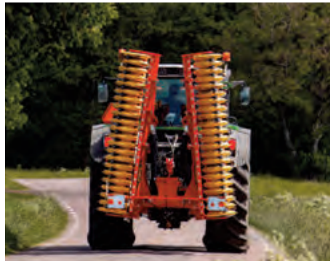
In Transportstellung ist Carrier X nur 2,4 m breit und bietet eine beeindruckende Bodenfreiheit.
