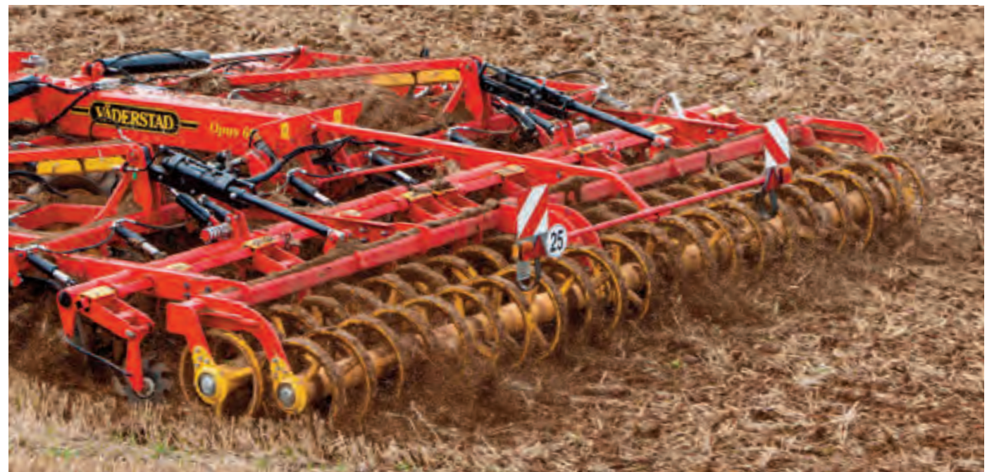
Die überlappende Doppelwalze SoilRunner mit U-Profil: hier arbeitet Boden auf Boden.
