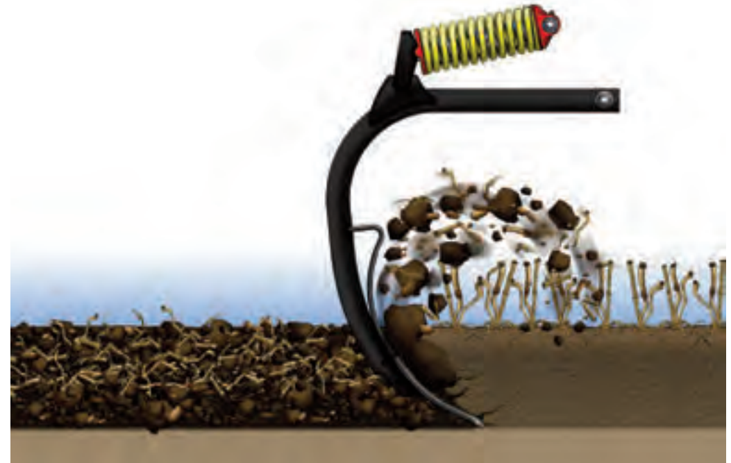
MixIn sorgt im gesamten Bearbeitungshorizont für feine Krümelung und Durchmischung.
