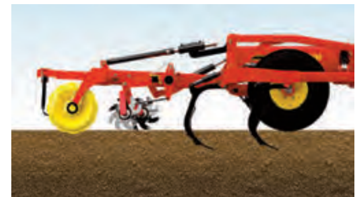
Umgekehrt lässt sich auf leichten Böden die Walze für eine lediglich oberflächliche Rückverfestigung ausheben.
