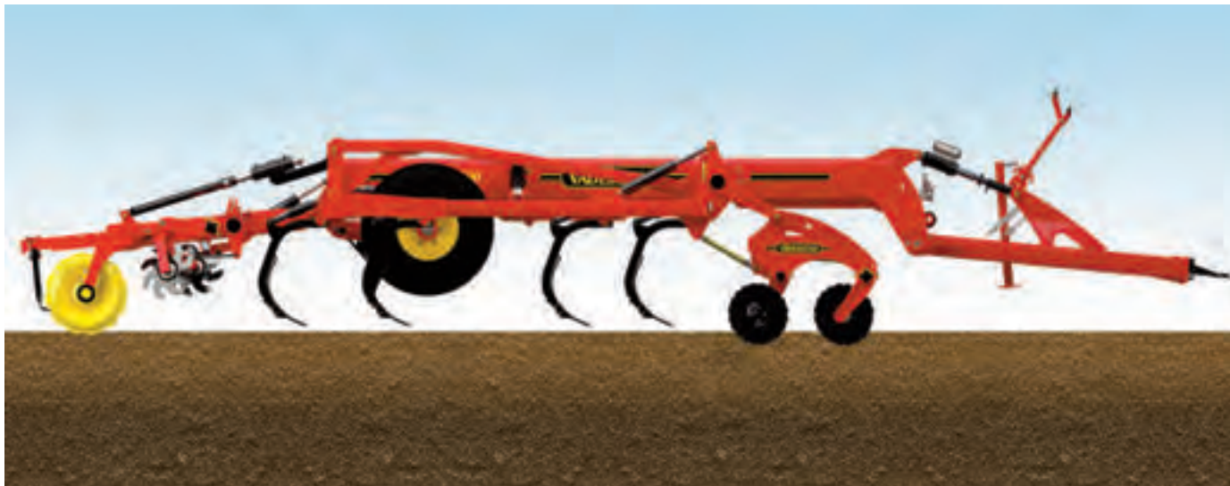
Flachgründige Bearbeitung: nur die Scheiben und die Walze sind im Eingriff.
