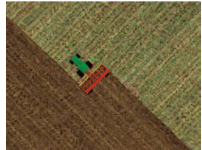
Der zweite Arbeitsgang erfolgt während des Zweiblattstadiums in einem Winkel von 90° zum ersten Arbeitsgang.
