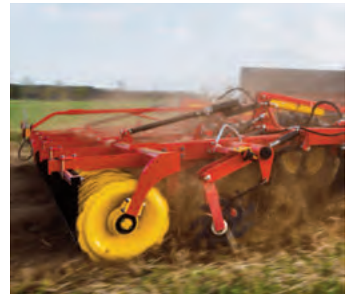
Die Stahlringwalze SteelRunner spleißt das aufliegende Stroh auf und drückt es für eine optimale Rotte oberflächlich ein.
