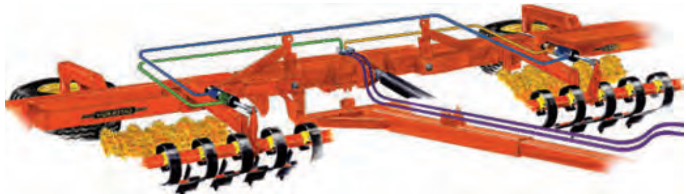
Eine Geber/Nehmer Hydraulik sorgt dafür, dass die einzelnen Packereinheiten alle Teilbreiten des CrossBoards gleichmäßig in der Tiefe führen.
