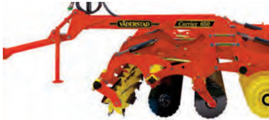
Flexibilität: CrossCutter Knife ist das Werkzeug für flache und tiefe Arbeit.
