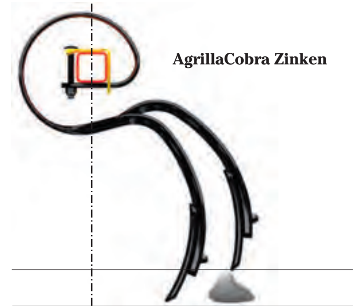
AgrillaCobra Zinken überzeugen durch ihren großen Ausweichwinkel und gute Tiefenführung.
