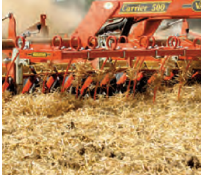
Der Strohriegel verteilt das Stroh gleichmäßig über die gesamte Arbeitsbreite.
