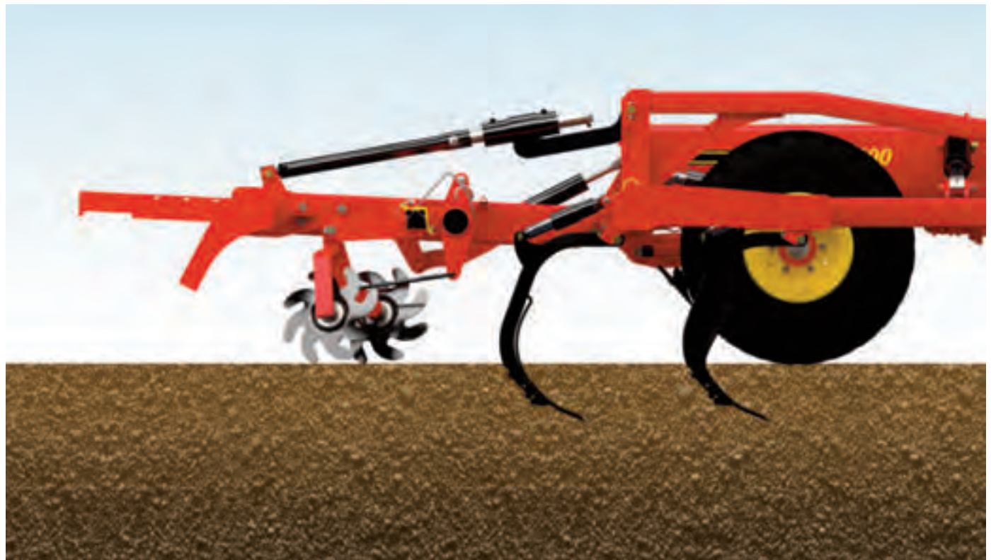
Zur Bearbeitung sehr feuchter Böden kann die Walze ganz abgebaut werden, um Gewicht zu sparen.
