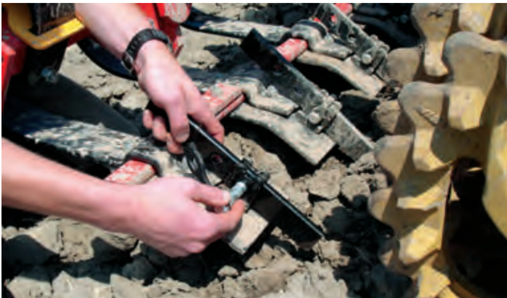
SingleKnife: Einfach montierbare CrossBoard Spitzen dank Väderstad QuickChange.
