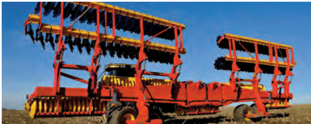
Der schwere Rahmen verleiht Carrier entsprechendes Gewicht und sorgt für zuverlässige Scheibenführung in der voreingestellten Tiefe.
