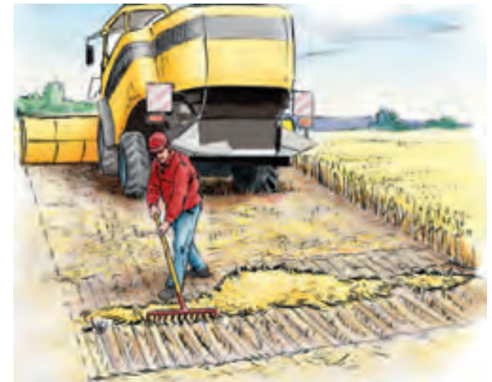
Man kann leicht überprüfen, wie gut das Stroh hinter dem Mäh-drescher verteilt wird, indem ein 1 m langer Abschnitt entsprechend der Breite des Mäh-dreschers zusammengerechnet wird.
