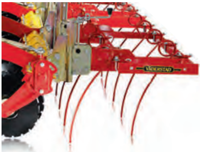
Der Strohriegel ist leicht zu montieren und in der Höhe verstellbar.
