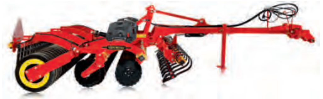
Carrier 300, 350 und 400 als gezogene Version mit und ohne CrossBoard – für hohe Wendigkeit und Schlagkraft.
