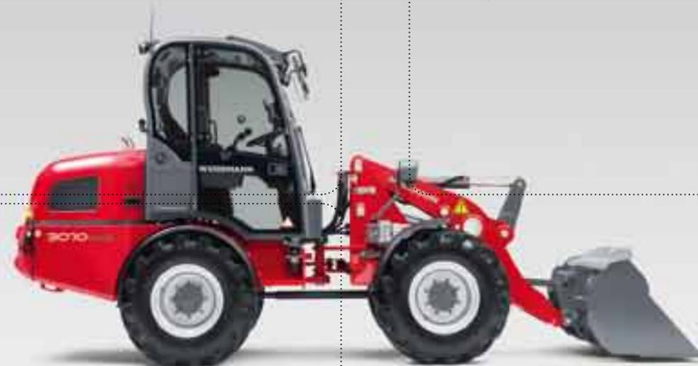
**Ein Profi-Paket.** 4-Zylinder-Motor für eine Fahrgeschwindigkeit bis 20 km/h. Hydrostatischer Allradantrieb. 100 % elektrisch-hydraulisch zuschaltbare Differenzialsperre an Vorder- und Hinterachse.
