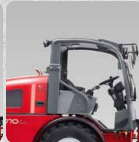
Mit der niedrigeren Version des Fahrerschutzdaches ist die Maschine überhaupt nur 2236 mm hoch und kann damit auch sehr geringe Durchfahrthöhen passieren.
