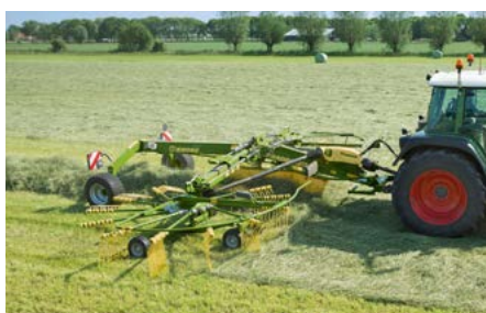
Zweikreisel-Mittelschwader Swadro TC und TC Plus Variable Arbeitsbreiten von 6,80 m bis 8,80 m
