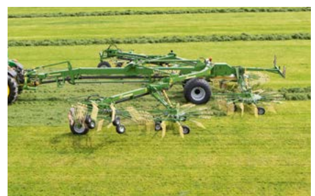
Sechskreisel-Mittelschwader Swadro 2000 Variable Arbeitsbreiten von 11,00 m bis 19,00 m
