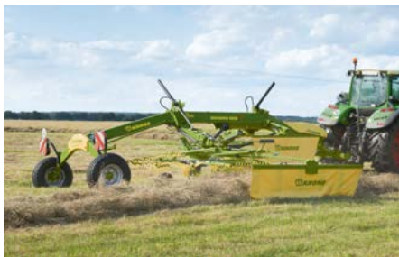
Zweikreisel-Seitenschwader Swadro TS und TS Twin Arbeitsbreiten von 6,20 m bis 8,20 m
