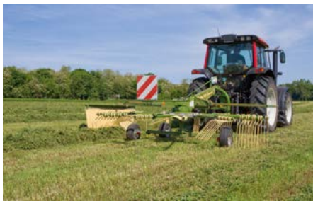
Einkreiselschwader Swadro, angebaut Arbeitsbreiten von 3,50 m bis 4,60 m
