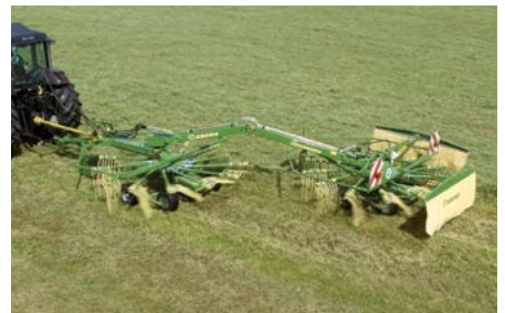
Zweikreisel-Seitenschwader Swadro 710/26T Arbeitsbreiten von 6,20 m oder 2x3,40 m
