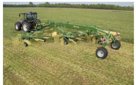
Zweikreisel-Seitenschwader Swadro 1010 Arbeitsbreiten von 9,70 m
