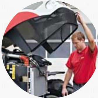
Einteilige gasdruckgefederte Motorhaube kann angehoben werden, sogar mit angebautem Frontanbaugerät.
