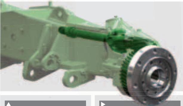
▲ **Portalachsen** mit Kegelrad-Untersetzungs-naben bieten eine **hervorragende Bodenfreiheit**, genauso wie eine hohe Laufruhe auf der Straße.
