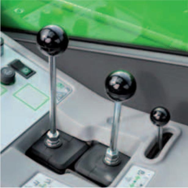
Die **Fahrstufenumschaltung und die Feststellbremse werden elektrisch betätigt**. Bei abgeschaltetem Antriebsmotor wird die Feststellbremse zudem automatisch aktiviert. Über ein **spezielles Inching-Pedal** kann der Bediener präzise die Fahrgeschwindigkeit steuern, ohne die Motordrehzahl zu verändern. Diese Funktion ist besonders bei der Nutzung von Schaufeln und anderen Lade-Anbaugeräten hilfreich.
