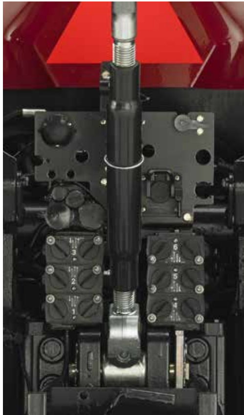
Unbegrenzte Einsatzmöglichkeiten mit sechs elektro-hydraulischen Steuerventilen im Heck.
