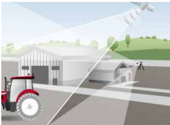
xFill überbrückt Ausfallzeiten des RTK-Signals bis zu 20 Minuten
