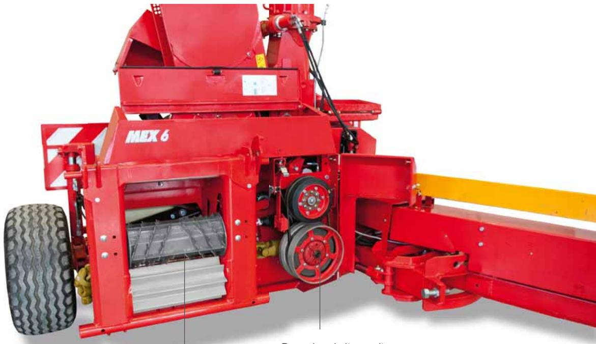
Reversierschaltung mit einfacher Schnittlängenverstellung
