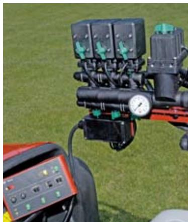
*Als Sonderausstattung kann eine elektrisch fernbediente EVC Armatur mit HARDI MATIC Dosierventil geliefert werden.*
