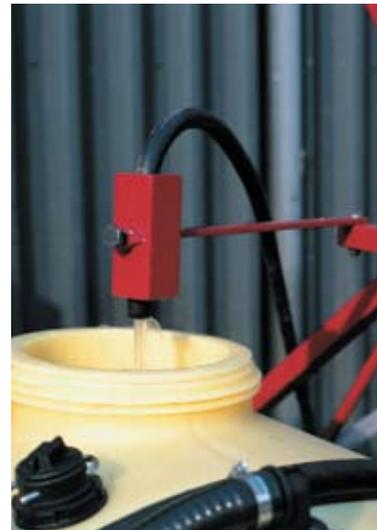
*Der Halter für den Befüllschlauch hält den Schlauch aus dem Behälter heraus. Dadurch werden unbeabsichtigte Kontakte mit der Spritzbrühe und ein Rücksaugen in die Füllleitung verhindert.*
