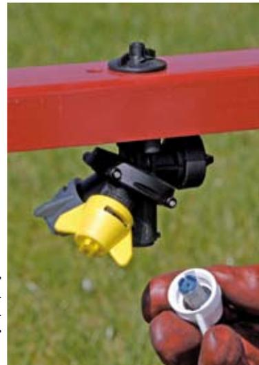
TRIPLET Düsenhalter mit Filtern und eingebauten Tropfstopp-Ventilen gehören zur Grundausrüstung.
