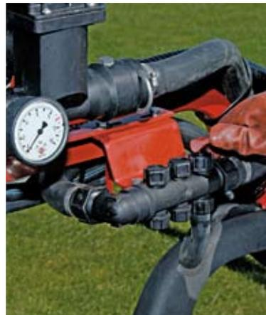
*Ein zusätzliches Ventil für Spritzlanze oder Spritzpistole gehört zur Standardausrüstung an allen Geräten.*
