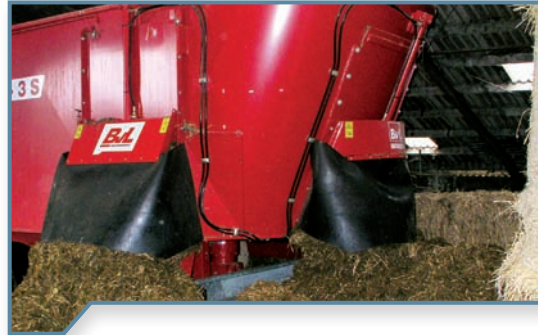
Austrageöffnung hinten li. und mi. im Heck
