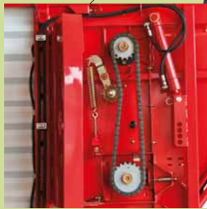
Kettenantrieb Zentrale Schmierleiste
