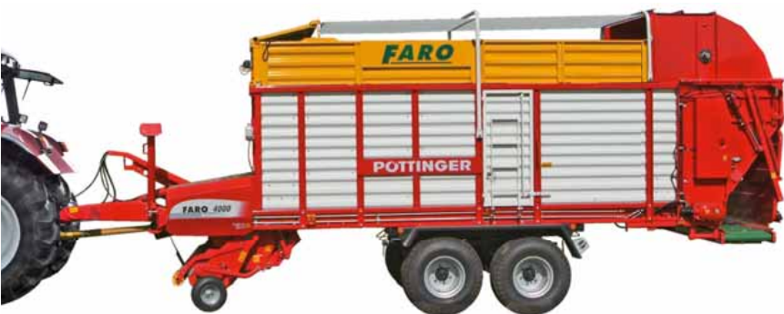
D Wagen – Ausführung mit Dosiereinrichtung (Option 3. Walze und Querförderband)
