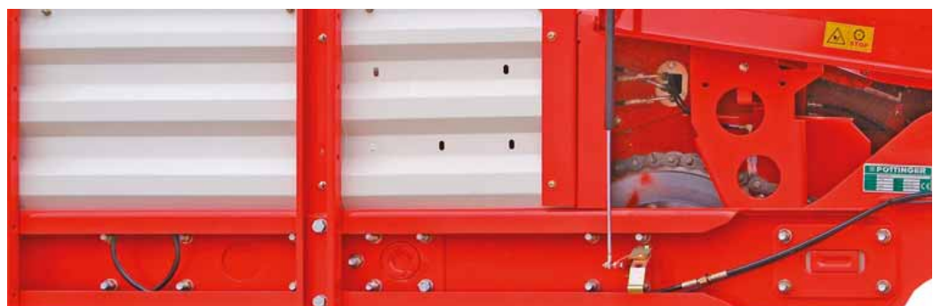
Geschraubte Rahmenkonstruktion – Feingewindeverschraubung
