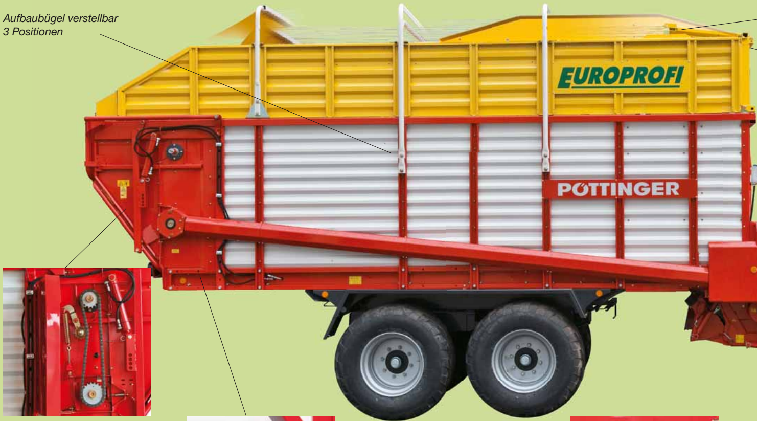
Kettenantrieb Zentrale Schmierleiste
