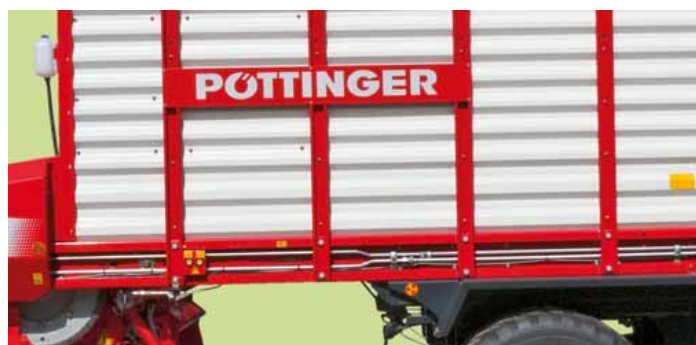
Profilwände mit Spezialbeschichtung – enge Steherabstände
