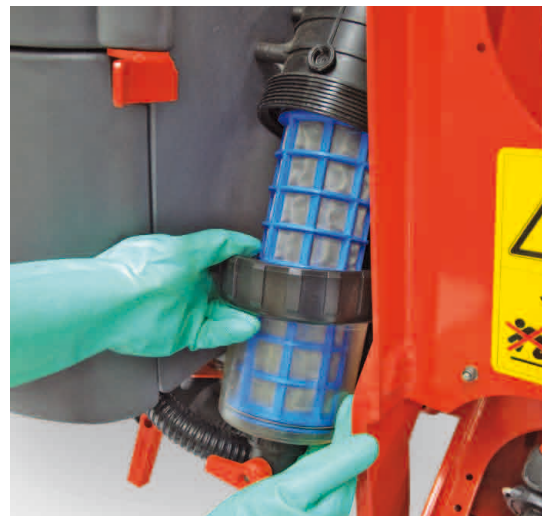
Saugfilter einfach kontrollieren und reinigen
