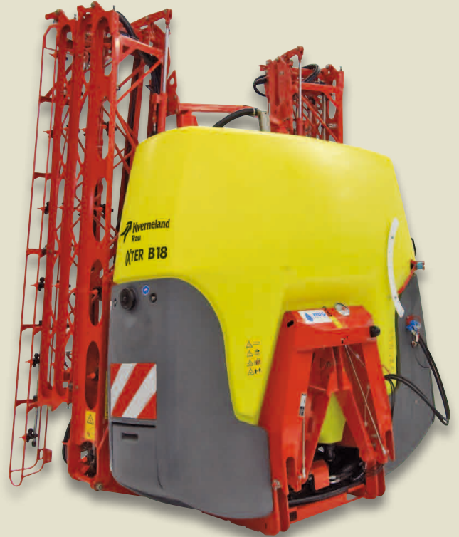
iXter mit HC 18-24 Stahl- Gestänge mit sektionaler Klappung
