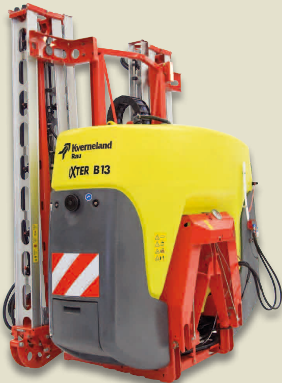
iXter mit HOSA 15 Gestänge mit Zeta - Klappung
