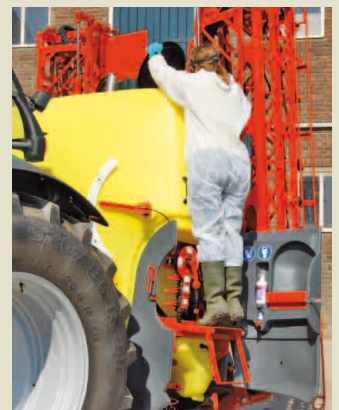
Saugfilter einfach kontrollieren und reinigen
