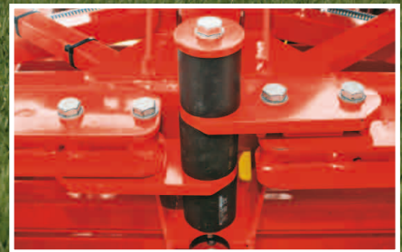
Unabhängige Aufhängung und Dämpfung der Ausleger
