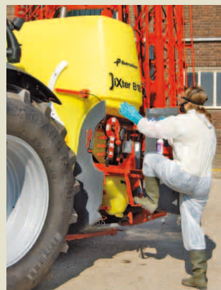
Saugfilter einfach kontrollieren und reinigen
