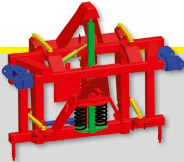
Die Mittelsektion verfügt über eine spiralfedergedämpfte Zentralpendelaufhängung und über hydraulische Dämpfer. Die horizontale Gestängebewegung und die Anfahr-/Abbremskräfte werden durch ein integriertes Anti-Swingsystem abgefangen. Die extrem robusten FORCE Gestänge werden mit 24 bis 36 m Arbeitsbreite angeboten.
