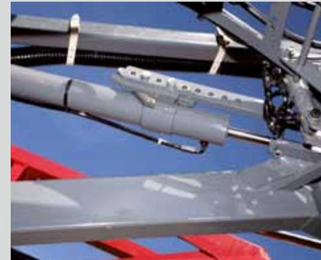
Die Gestängehöhe wird über den PARALIFT Aufzug eingestellt, die beiden Hubzylinder ziehen das Gestänge nach oben. In Transportposition wird das Parallelogramm automatisch verriegelt, dieses sorgt für zusätzliche Sicherheit im Transport und erhöht die Lebensdauer der Ausleger.
